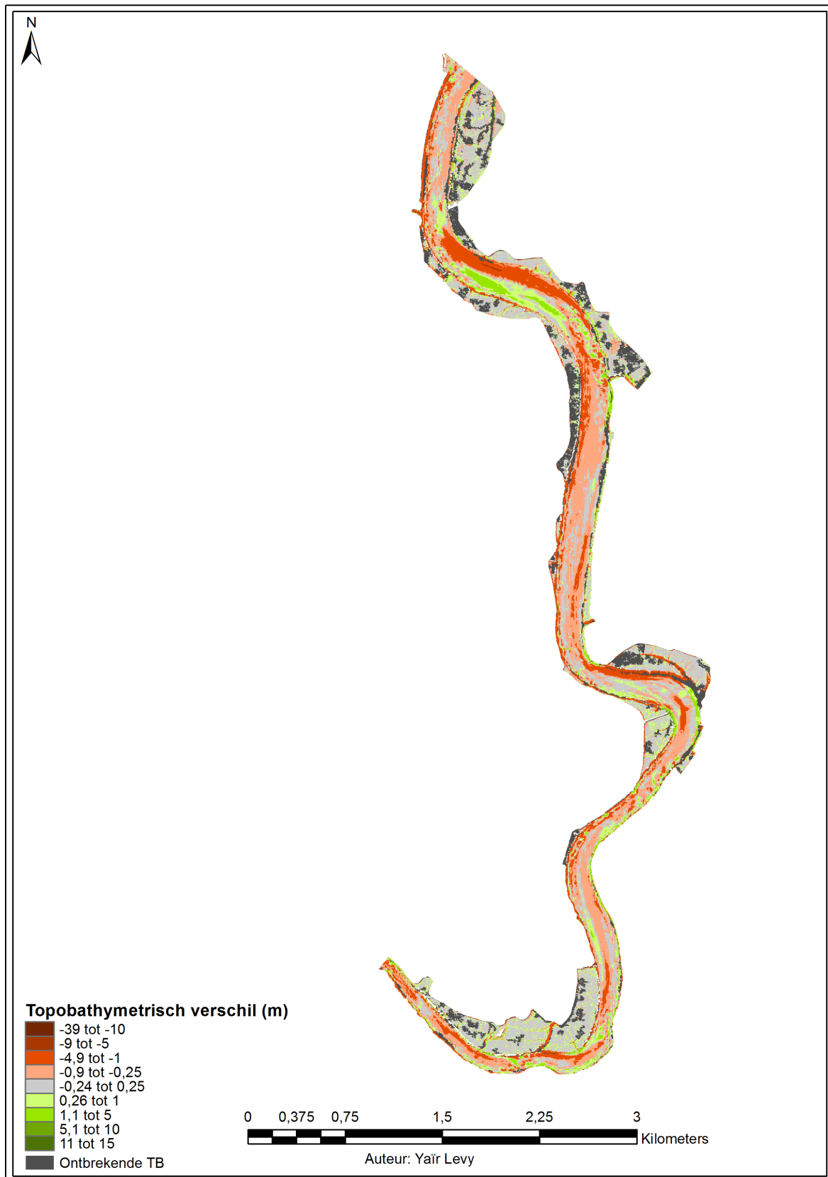
Figuur 42 – Verschilkaart voor rekencel 15 op basis van de 2001 en 2011 topo-bathymetrieën
