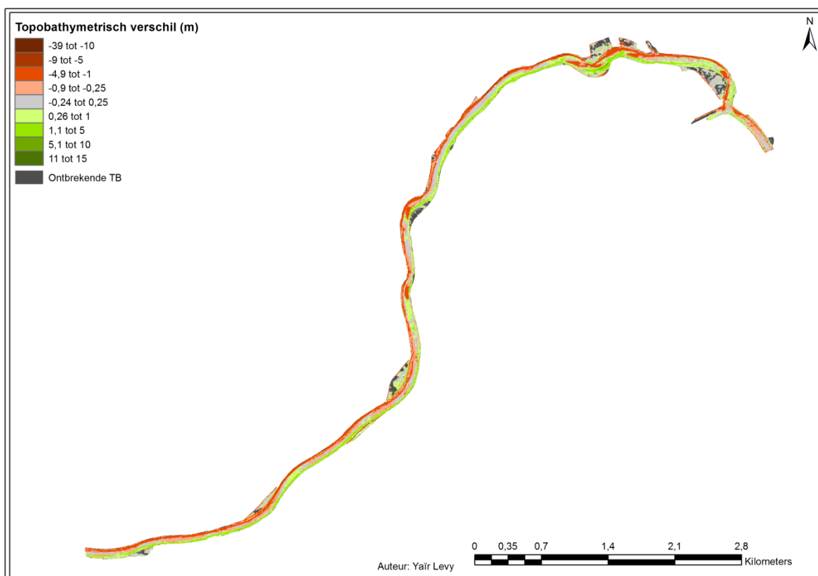
Figuur 44 – Verschilkaart voor rekencel 17 op basis van de 2001 en 2011 topo-bathymetrieën
