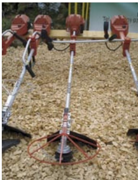
Bosmaaier met opklapbare metalen beschermring
