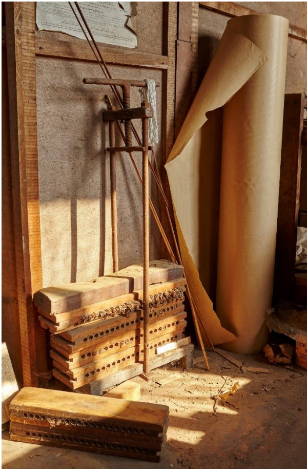
Fig. 150 - Metalen vormenpers in de sigarenfabriek Borremans in Geraardsbergen (Collectie Onroerend Erfgoed, foto Kris Vandevorst).
