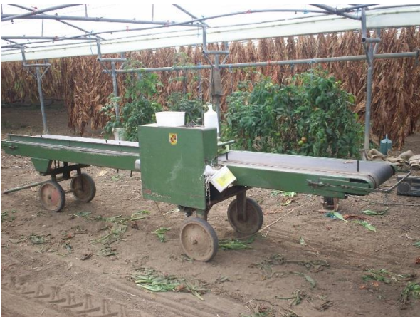
Fig. 8 - Een tabaksnaimachine (Collectie Nationaal Tabaksmuseum, Wervik).
