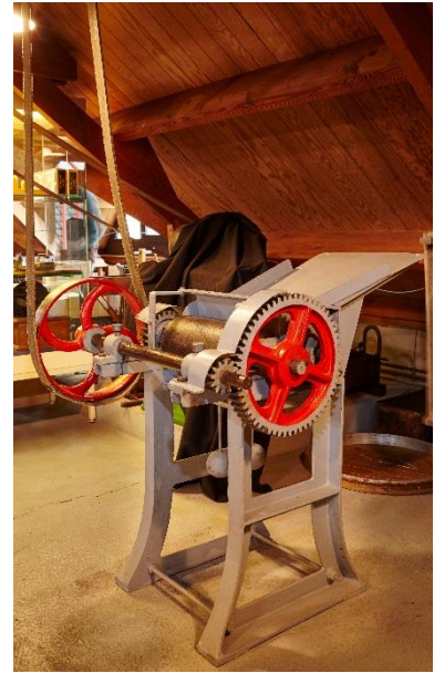
Fig. 86 - Kerfrij met ecoteermachine (Bère 1895). Fig. 87 - Een pletter voor tabaksnerven (in het Nationaal Tabaksmuseum) (Onroerend Erfgoed, foto Kris Vandevorst).
