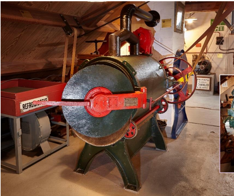
Fig. 109 - Droogtrommel met ijzeren harken en scheppen voor het keren van de tabak (in het Nationaal Tabaksmuseum) (Collectie Onroerend Erfgoed, foto Kris Vandevorst).
