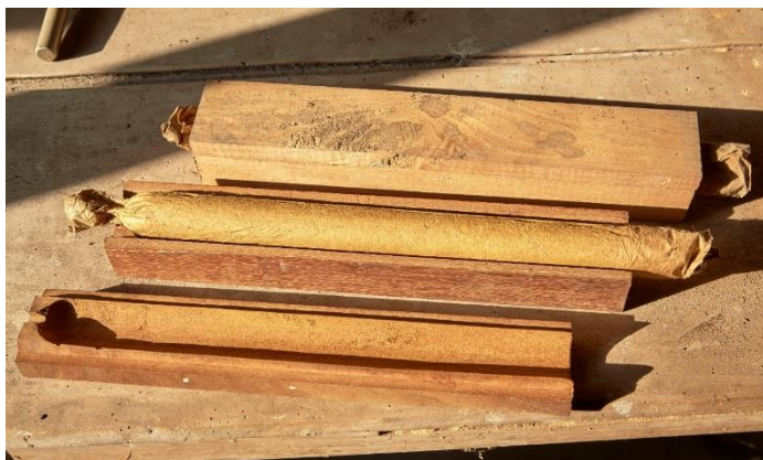
Fig. 146 - Hardhouten kokertje om het bosje zijn gewenste vorm te geven (in de sigarenfabriek Borremans in Geraardsbergen) (Collectie Onroerend Erfgoed, foto Kris Vandevorst).
