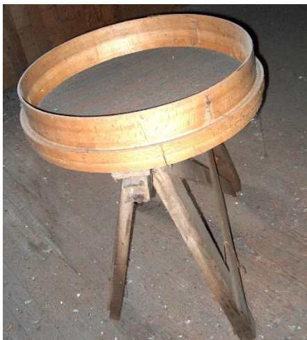
Fig. 134 - Snuifzeef, die bij het zeven krachtig heen en weer werd geschoven op een houten paard (Collectie Adriaen, Poperinge).
