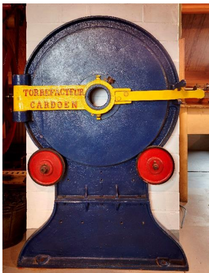
Fig. 253 - Deksel van eesttrommel van de Vlaamse firma Cardoen (in het Nationaal Tabaksmuseum in Wervik) (Collectie Onroerend Erfgoed, foto Kris Vandevorst).
