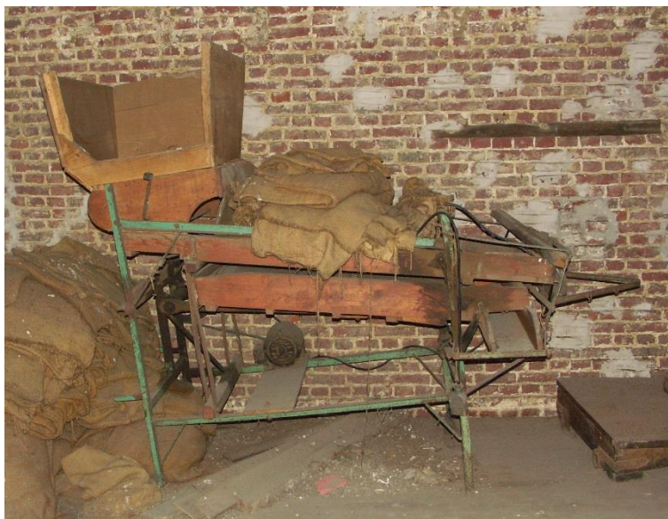
Fig. 134 - Snuifzeef, die bij het zeven krachtig heen en weer werd geschoven op een houten paard (Collectie Adriaen, Poperinge).
