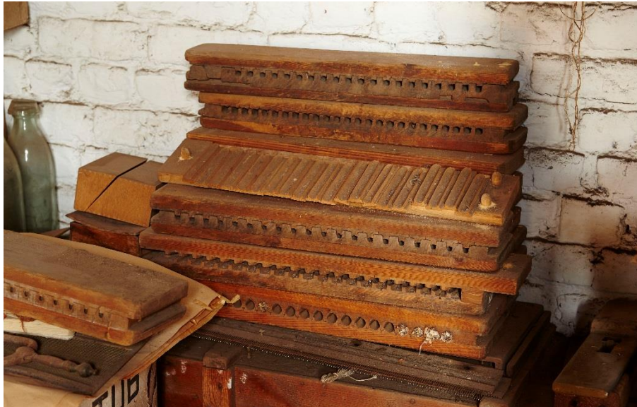
Fig. 148 - Houten persvormen in de sigarenfabriek Borremans in Geraardsbergen (Collectie Onroerend Erfgoed, foto Kris Vandevorst).
