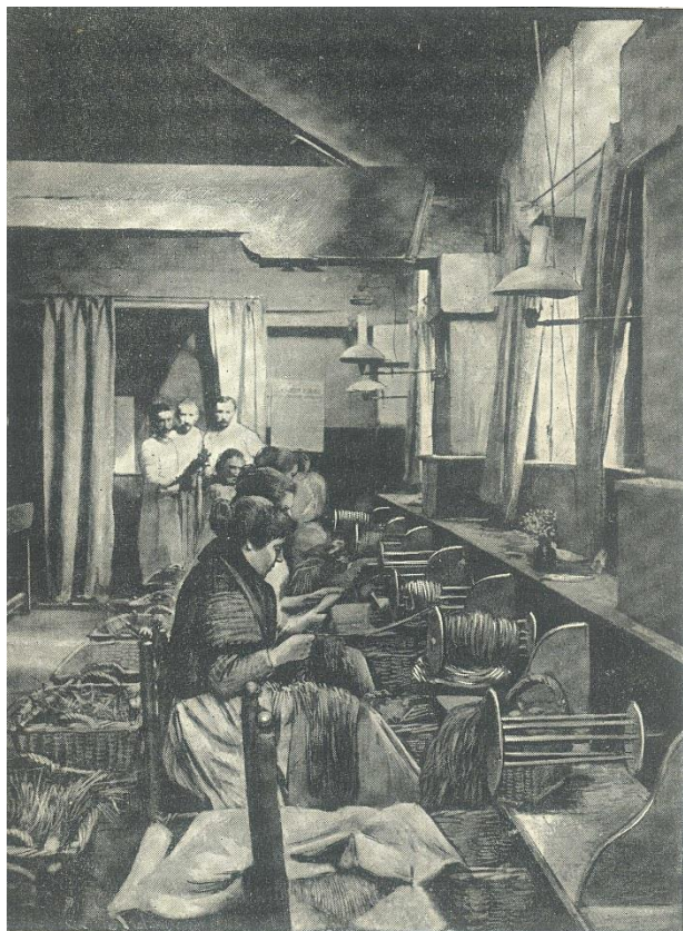
Fig. 119 - Het spinnen van pruimtabak (Bère 1895).
