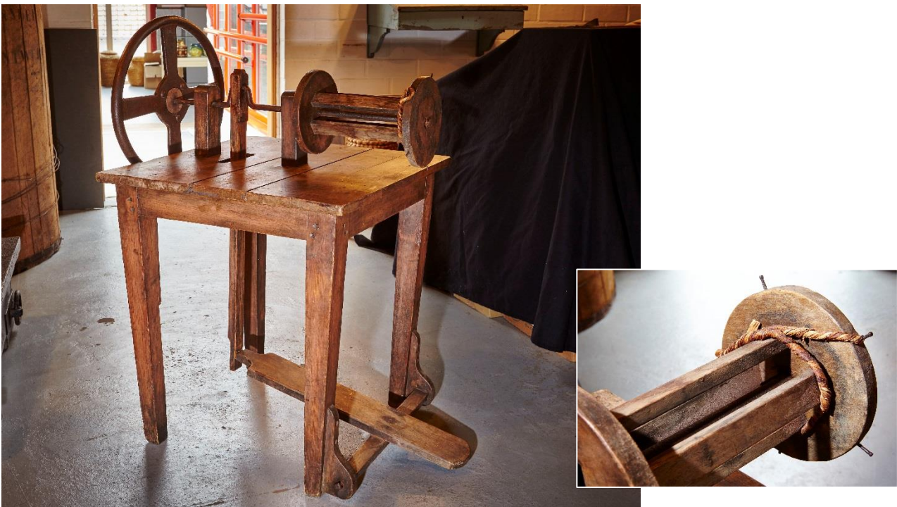
Fig. 121 - Een spinmachine met pedaalwerk (in het Nationaal Tabaksmuseum in Wervik) (Collectie Onroerend Erfgoed, foto Kris Vandevorst).
