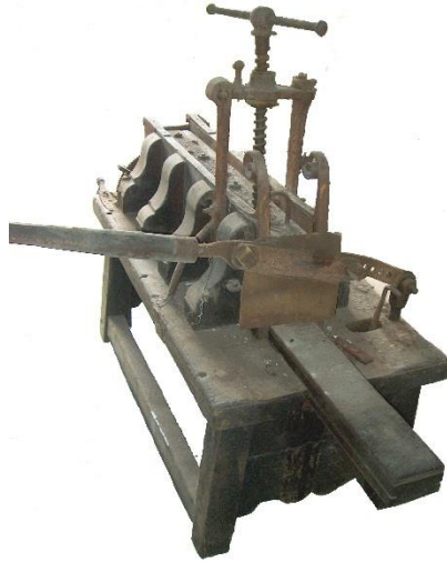
Fig. 93 - Een 18de-eeuws houten kerftoestel (in het Nationaal Tabaksmuseum) (Collectie Onroerend Erfgoed, foto Kris Vandevorst).
