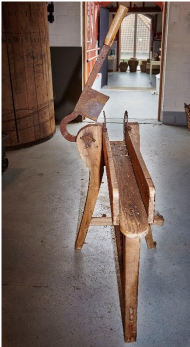
Fig. 93 - Een 18de-eeuws houten kerftoestel (in het Nationaal Tabaksmuseum) (Collectie Onroerend Erfgoed, foto Kris Vandevorst).
