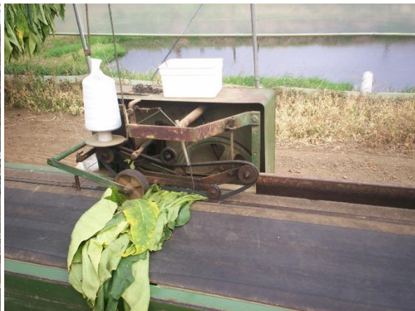
Fig. 9 - Tabak in tabaksnaimachine (Collectie Nationaal Tabaksmuseum, Wervik).
