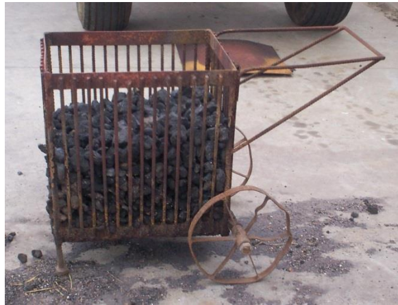
Fig. 32 - De metalen vuurkorf, gebruikt in de tabaksast in de Oude Beselarestreet in Wervik bij het buiten gebruik stellen van het buizensysteem (Collectie Nationaal Tabaksmuseum, Wervik).
