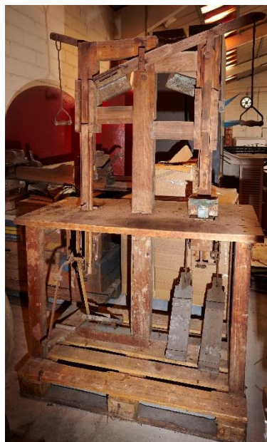
Fig. 116 - Een manueel te bedienen verpakkingstoestel (in het Nationaal Tabaksmuseum) (Collectie Onroerend Erfgoed, foto Kris Vandevorst).
