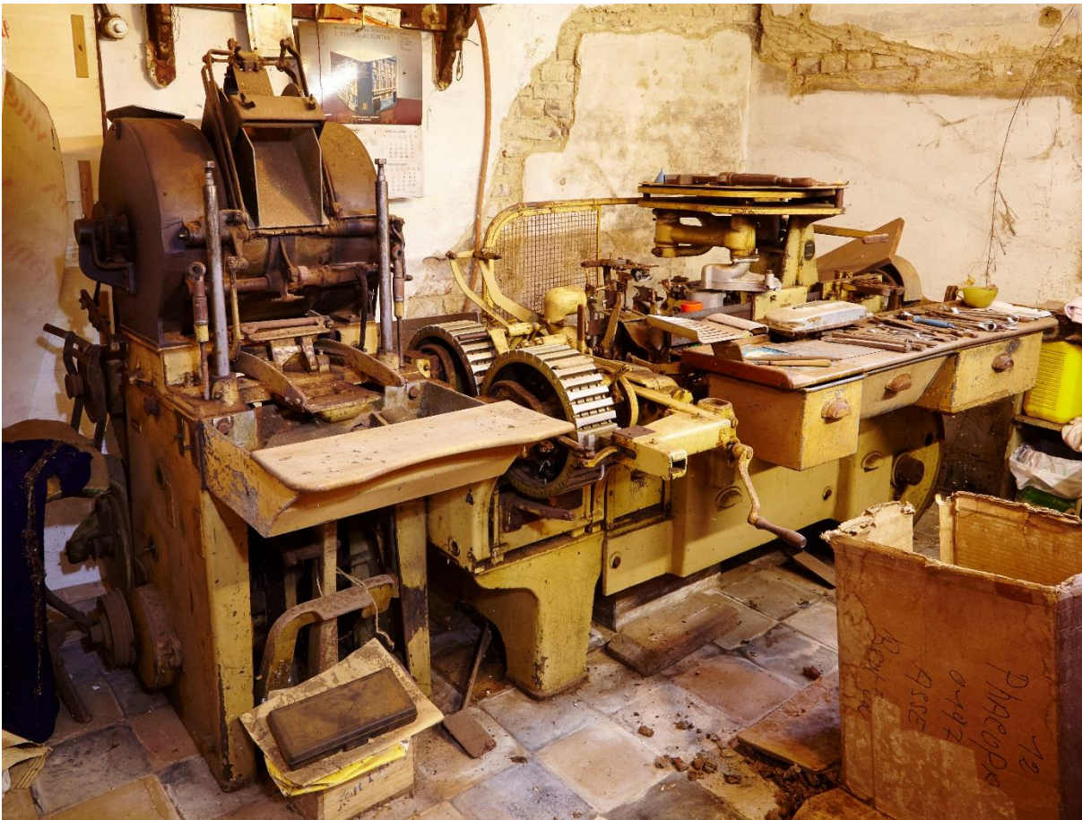
Fig. 158 - De compleetmachine voor de productie van cigarillo's in de sigarenfabriek Borremans in Geraardsbergen (Collectie Onroerend Erfgoed, foto Kris Vandevorst).
