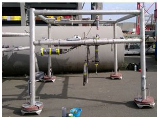
Figuur 2 . Frame met meetinstrumenten (LxBxH: 2 m x 2 m x 1,8 m – gewicht: 1 ton).
