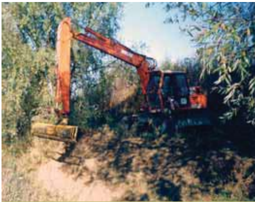
De korfmaaier wordt gebruikt wanneer zowel onder als boven het waterniveau moet gemaaid worden.
