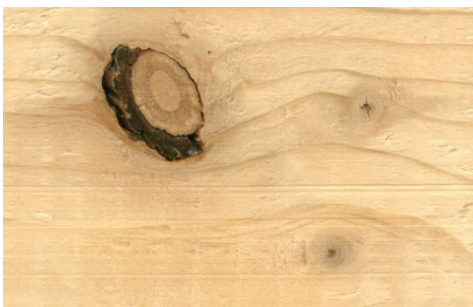
Figuur 30-1-3: Een (grote) losse kwast en twee (kleine) vaste kwasten in grenenhout
