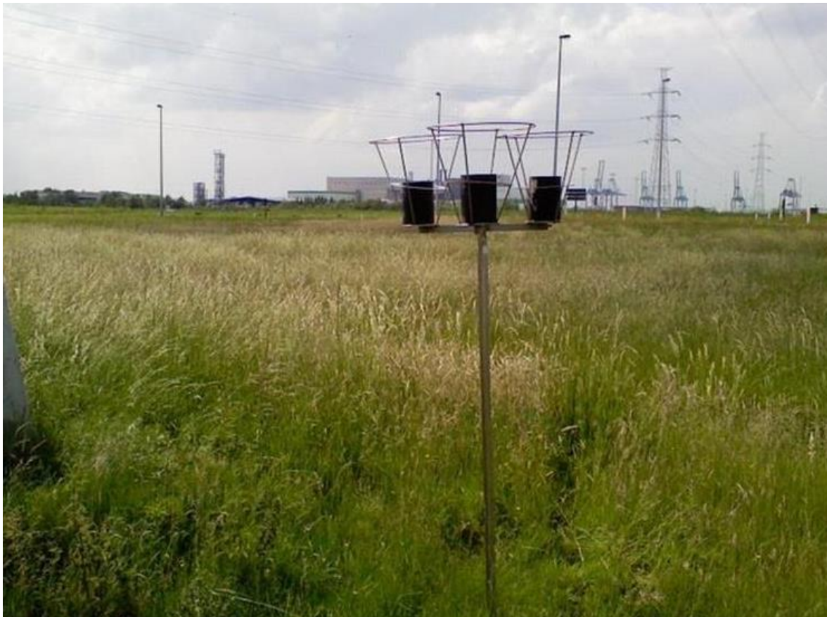
Figuur 38: Statief voor monstername depositie dioxines en PCB's
