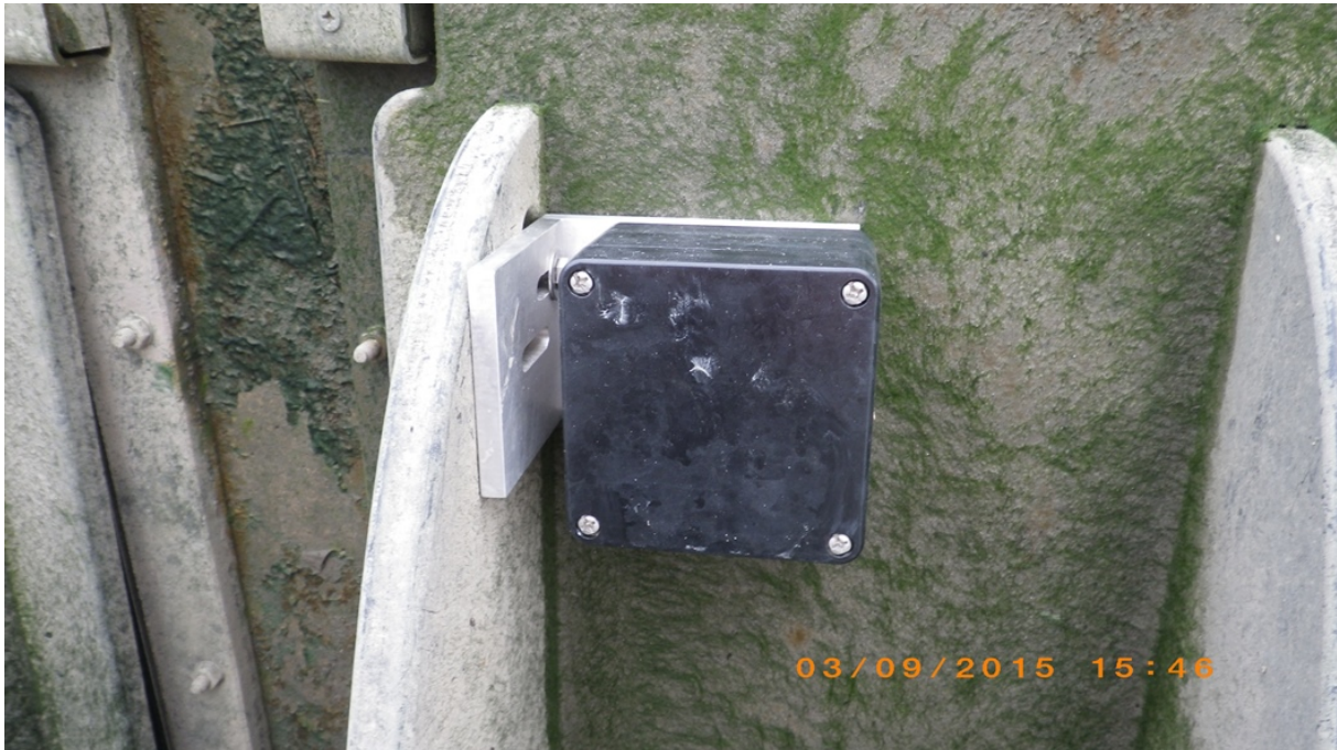
Figuur 16 – Meetsysteem helling terugslagklep bevestigd doorheen een hijsoog van de terugslagklep
