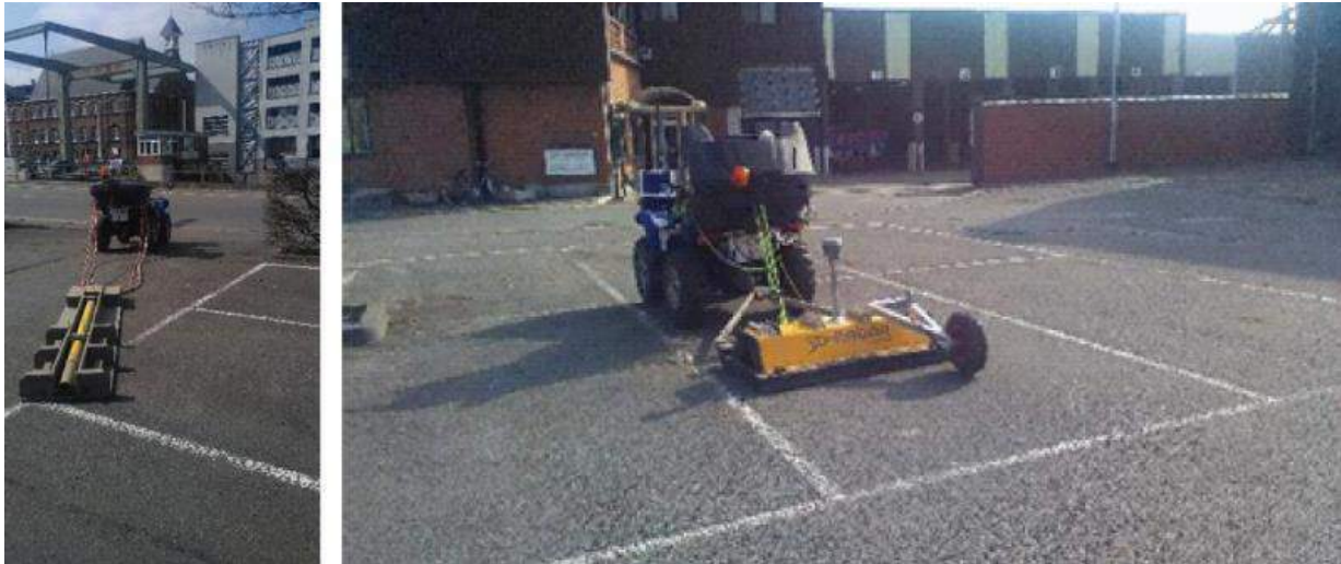
Figuur 40 Mobiele sensorconfiguratie met de EMI sensor in de slede en RTK-GPS (links), de mobiele GPR meetconfiguratie in werking op de site (rechts).
