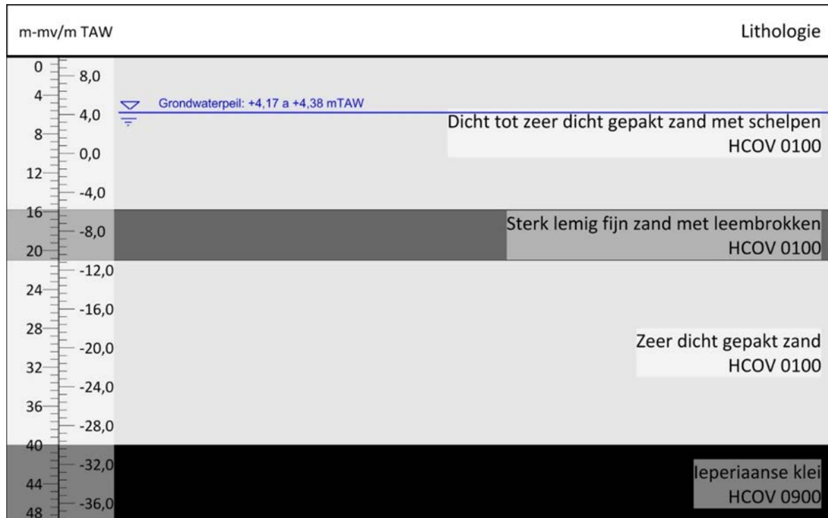
Figuur 73 lokaal hydrogeologisch profiel
