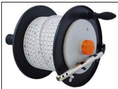
Figuur 7 waterpeilmeetlint en dataloggers voor het opmeten van de grondwaterstand
