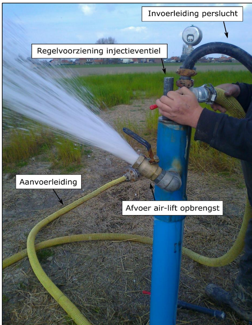
Figuur 42 illustratie van een putkop van een retourbron, met aanduiding van enkele essentiële elementen
