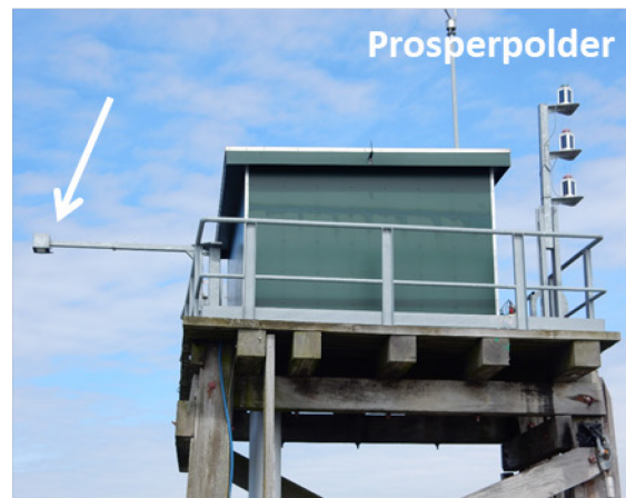
Figuur 2 – Opstelling radar voor de getijposten Antwerpen en Prosperpolder
