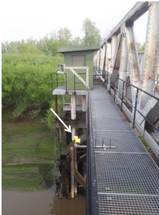
Figuur 6 – Mobiele radar (geel meettoestel) tijdelijk geïnstalleerd ter hoogte van Waasmunster Brug
