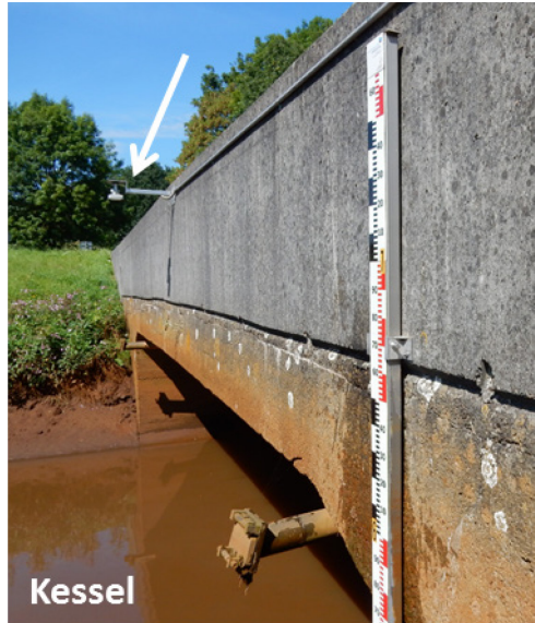
Figuur 3 – Radararm bevestigd aan brug getijpost Kessel
