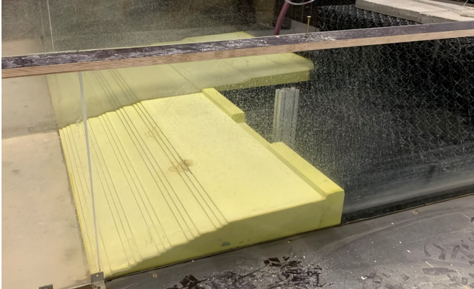
Figuur 68 – Details opstelling golfoverslag modelsectie MK05 (afmetingen in mm)
