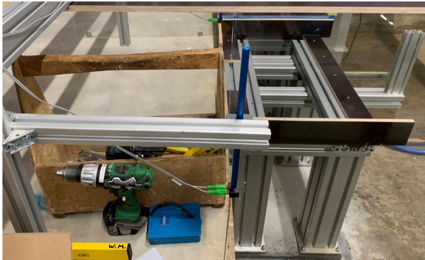
Figuur 8 – Verbinding load cells op meetframe krachten, modelopstelling MK02
