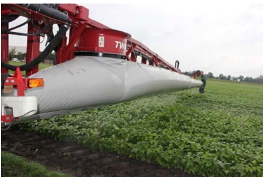
Afbeelding 9: Spuiten met luchtondersteuning als driftreducerende maatregel
