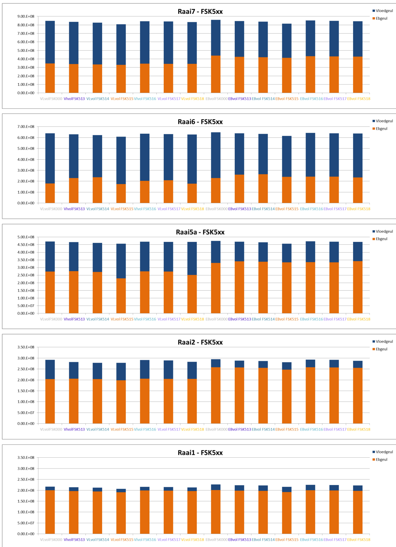
Figuur 18 – Vloed en ebvolumes in vloed- en ebgeul ter hoogte van de raaien 7, 6, 5a, 2 en 1 voor vervolgsenario's
