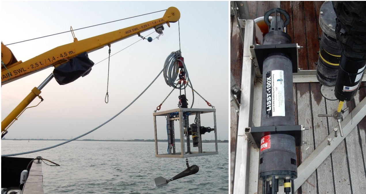
Figuur 6 – Meetframe (links) en detail (rechts) meettoestellen: LISST-100X en Sontek-Vector
