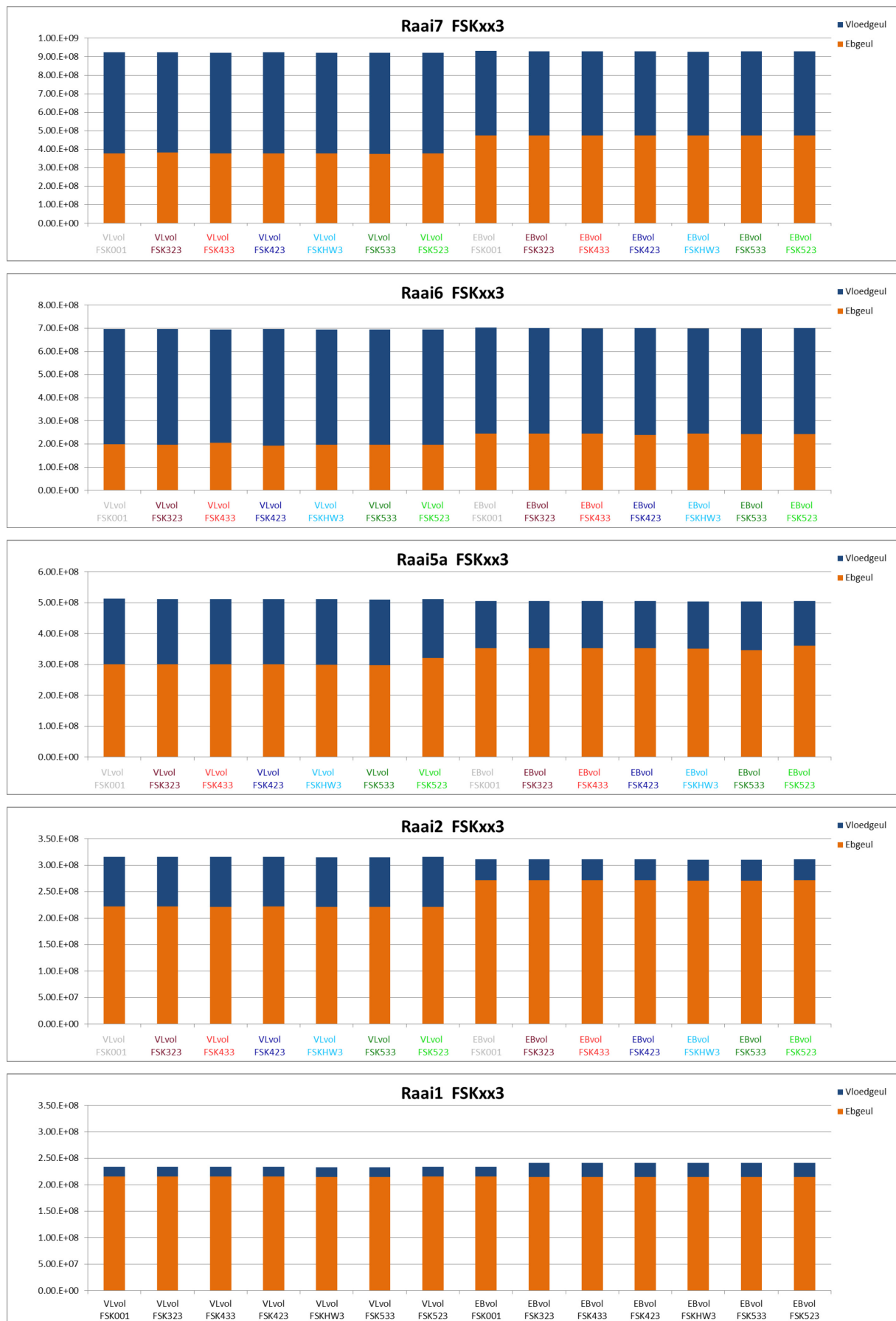
Figuur 40 – Vloed- en ebvolumes in vloed- en ebgeul ter hoogte van raaien 7, 6, 5a, 2 en 1 voor scenario's met storting 4 Mm 3
