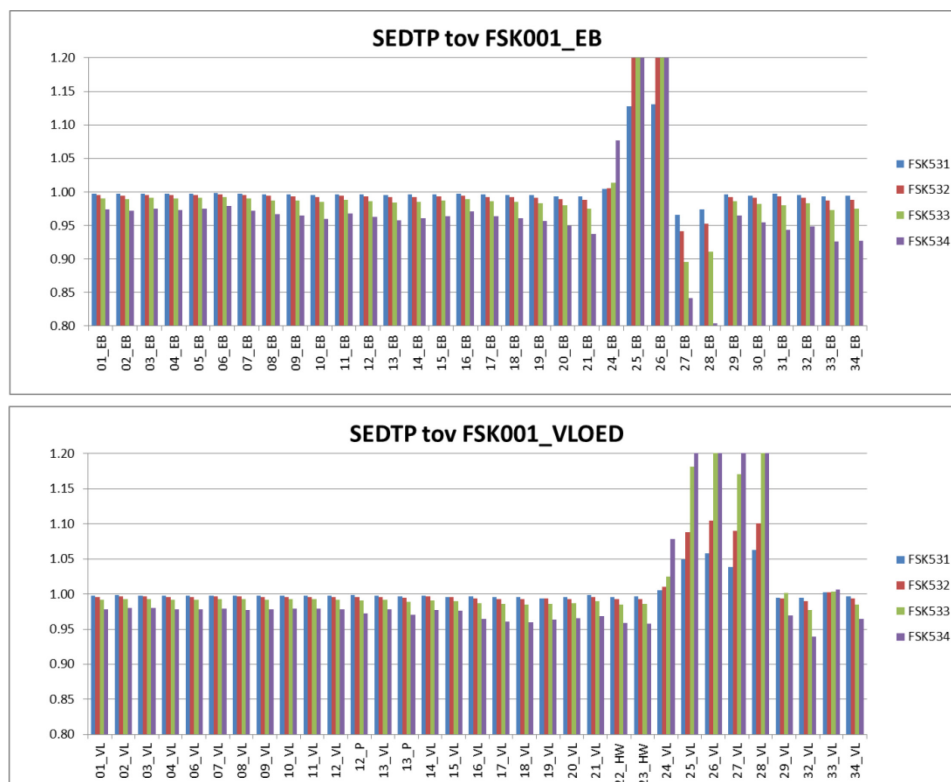
Figuur 32 – Bruto sedimenttransport over dwarsdoorsneden langs ebgeul (boven) en vloedgeul (onder) nabij stortvak SH51 voor scenario's met stortingen in stortvak SH51
