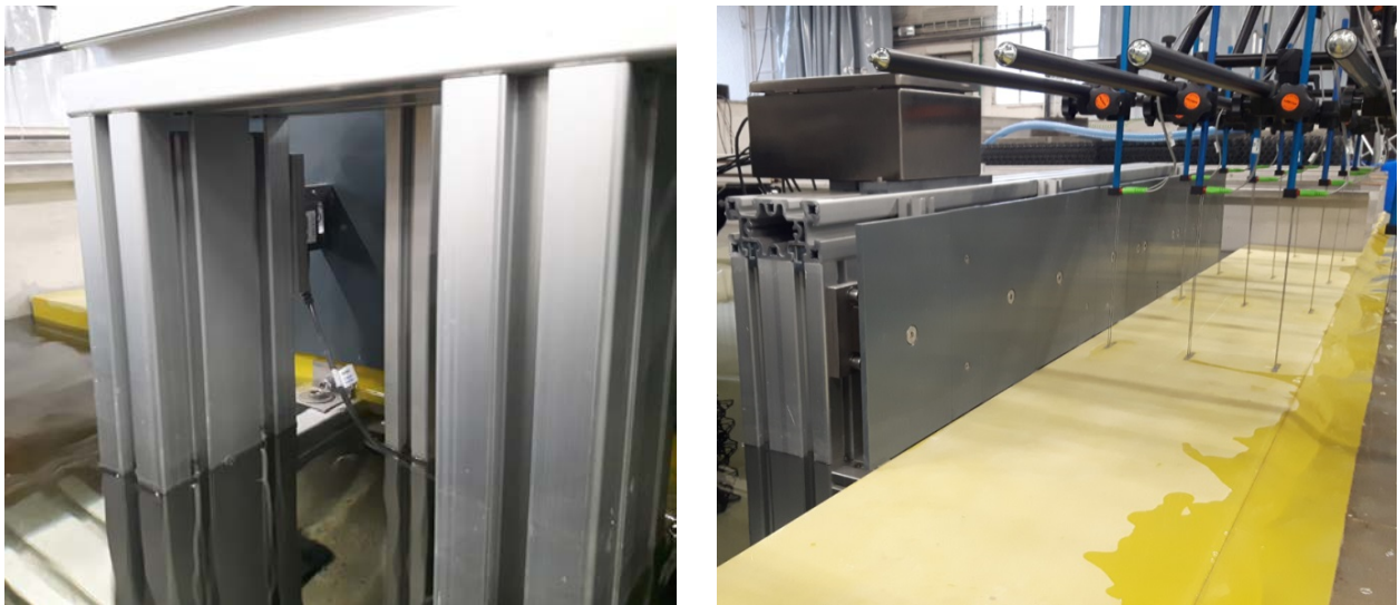
Figuur 8 – stalen constructie waarop de sensoren werden gemonteerd
