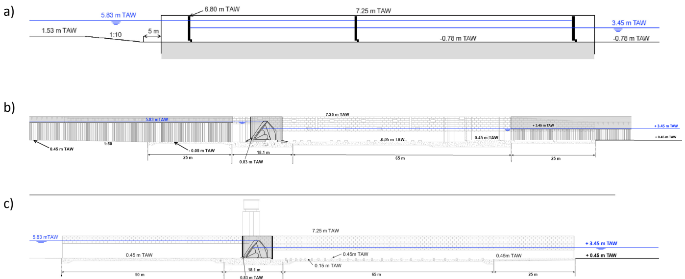
Figuur 3 – Dwarsdoorsnede nieuwe sluis en stuwen
