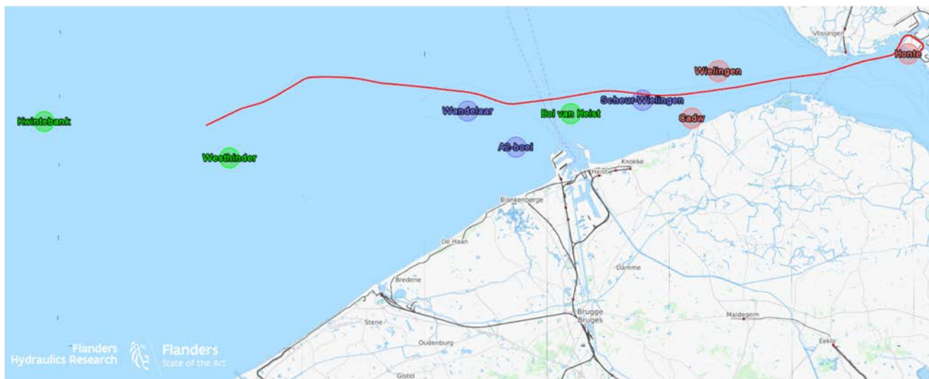
Figuur 6 – Golfmeetboeien binnen het Meetnet Vlaamse Banken (directioneel (groen) en non-directioneel (blauw)) en binnen het Landelijk Meetnet Water (non-directioneel (rood)) gecombineerd met het vaartraject van de Wisdom of the Sea op 24/09/2015.
