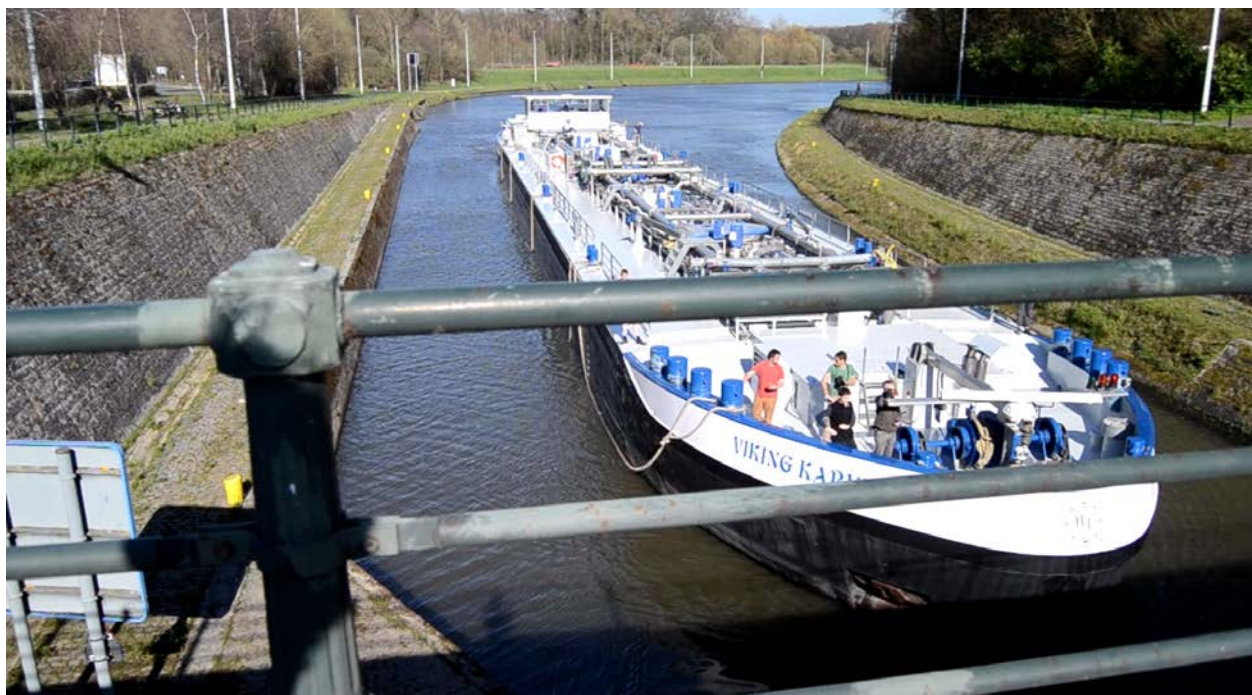
Figuur 6 – Aanloop van de sluis te Lembeek door de Viking Karve met scheepstouwen als fendering
