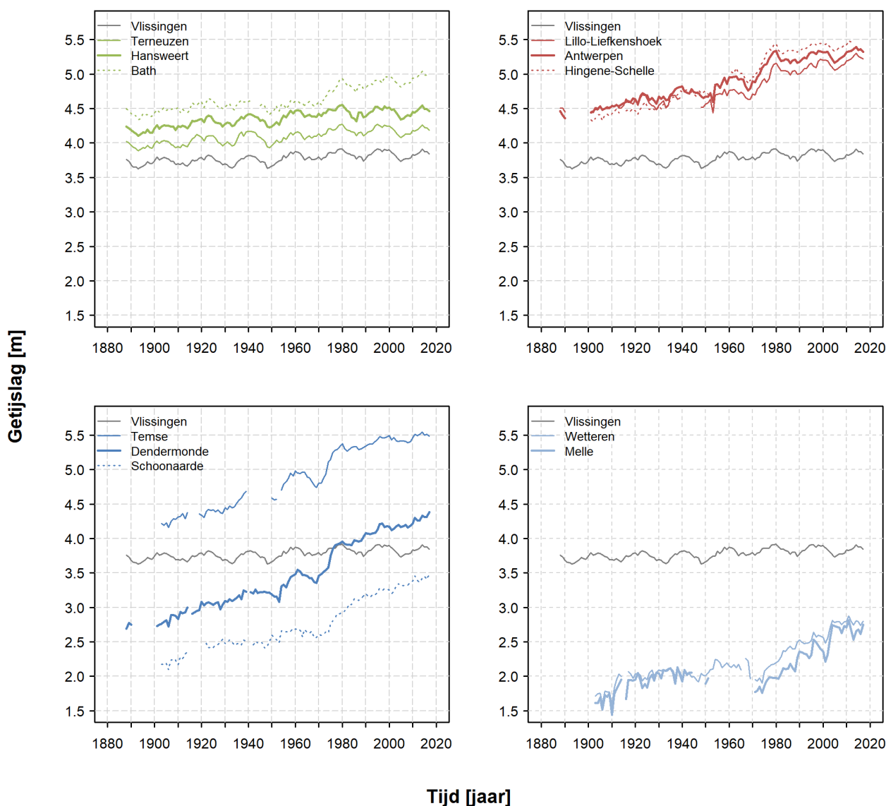
Figuur 13 – Evolutie van de getijslag bij gemiddelde tijcondities voor de getijposten in de Westerschelde (groen), Beneden-Zeeschelde (rood), en Boven-Zeeschelde (blauw). Vlissingen wordt ter referentie in het grijs weergegeven.
