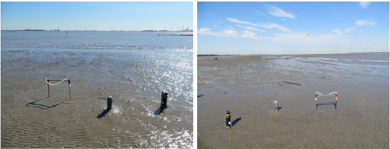
Figuur 7 – Meetinstrumenten (NIOZ sedsenosr, Aquadopp® en druksensor) ter hoogte van Saefthinghe-Noord
