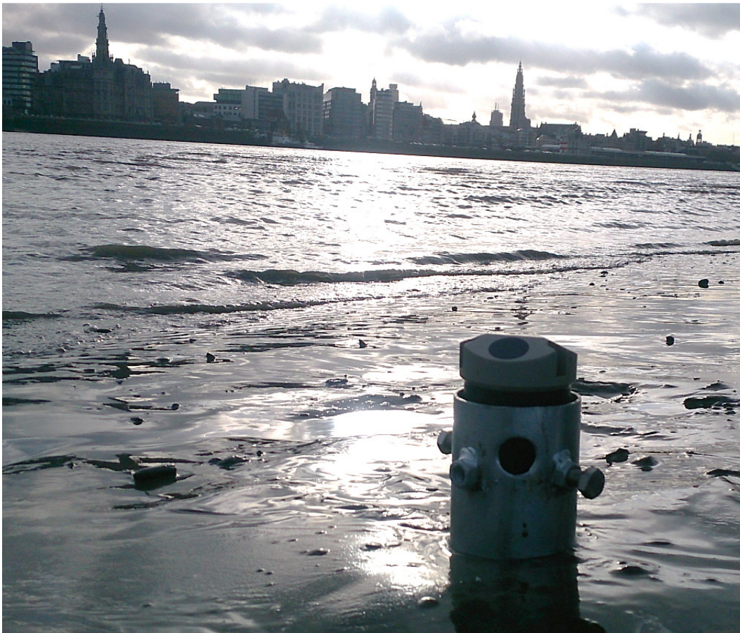
Figuur 2 – Installatie van Aquadopp ® op laag slik ter hoogte van Palingplaat
