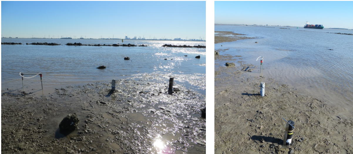
Figuur 6 – Meetinstrumenten (NIOZ sedsenosr, Aquadopp® en druksensor) ter hoogte van Saefthinghe-Zuid
