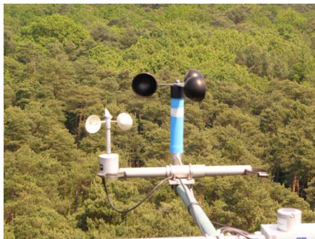
Figuur 4: Siggelkow cup anemometer (in blauw) naast oude Didcot-sensor.
