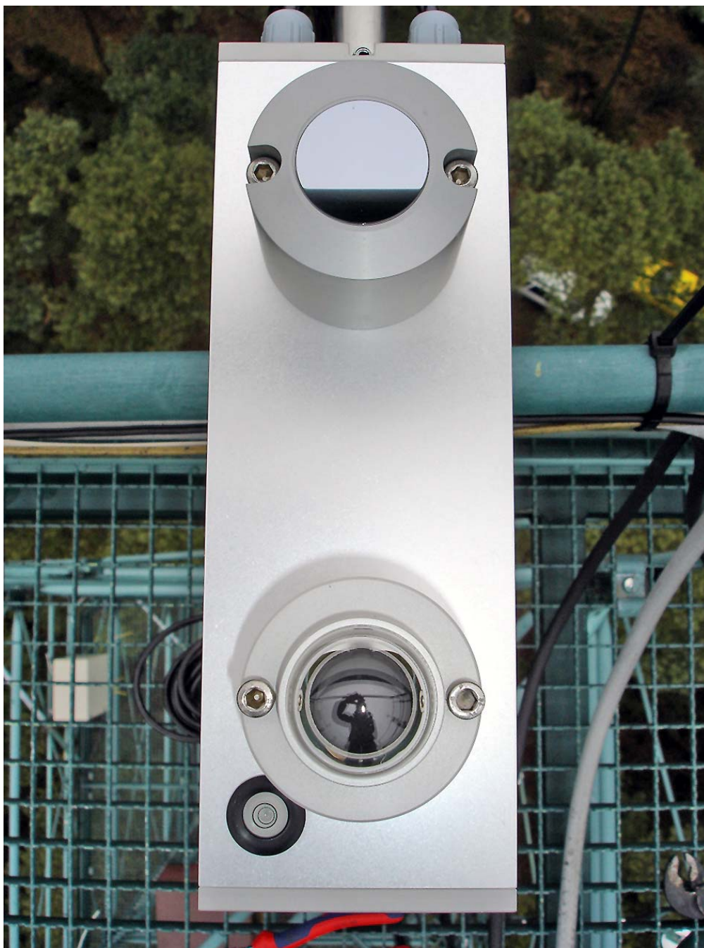
Figuur 5: CNR1 radiometer met CM3-solarimeter (onder) en CG3-pyrgeometer (bovenaan)
