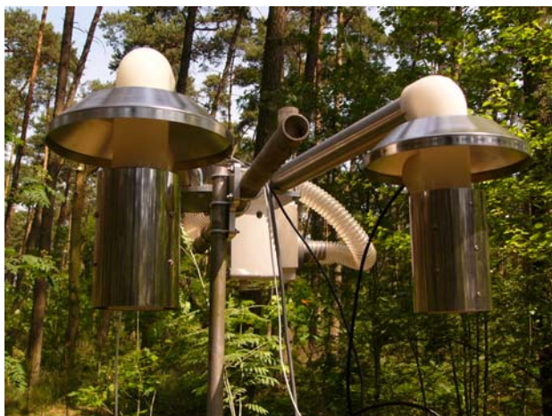
Figuur 3: Shield voor RV en T sensor ventilatie.
