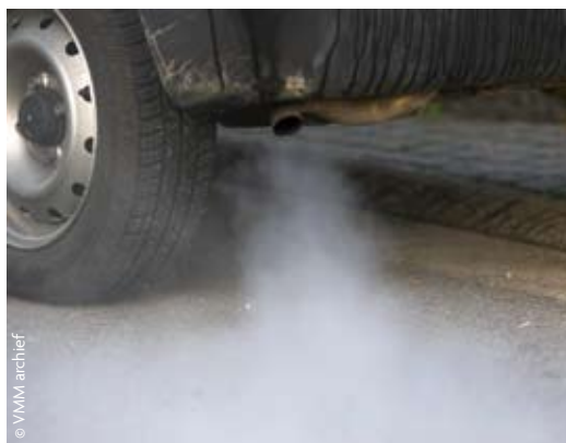
Aan 90 km per uur stoot een dieselauto 25 tot 30% minder dieselroet uit dan aan 120 km per uur.
