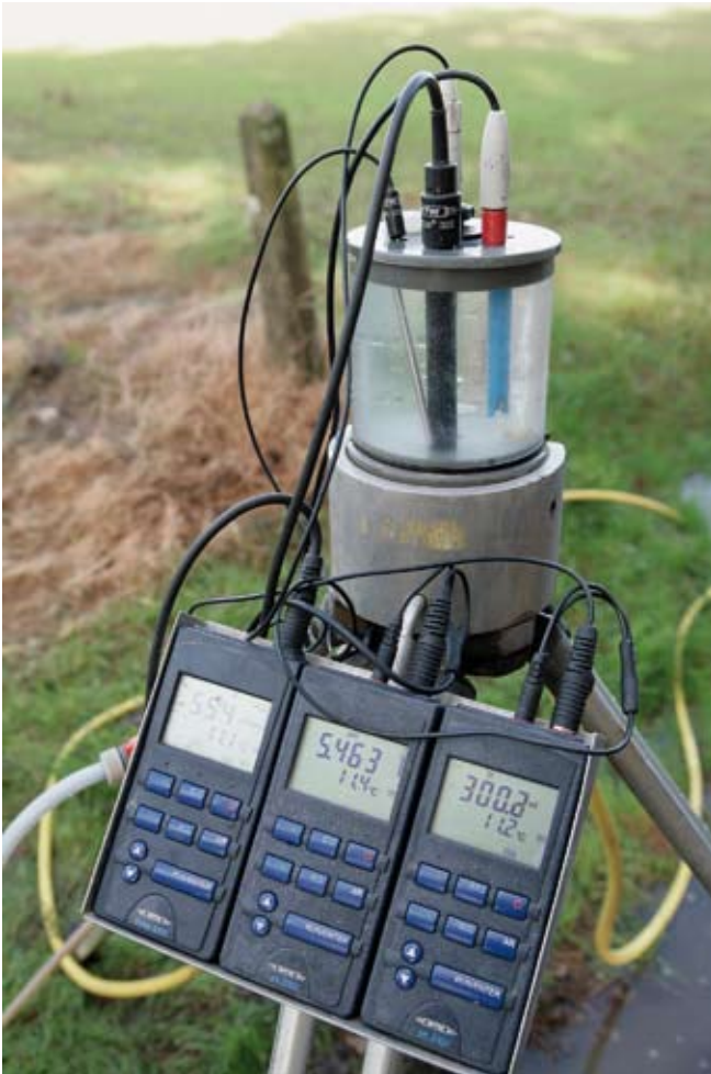
Het grondwater wordt door een doorstroomcel gepompt, omdat het voor bepaalde analyses niet in contact mag komen met de lucht.
