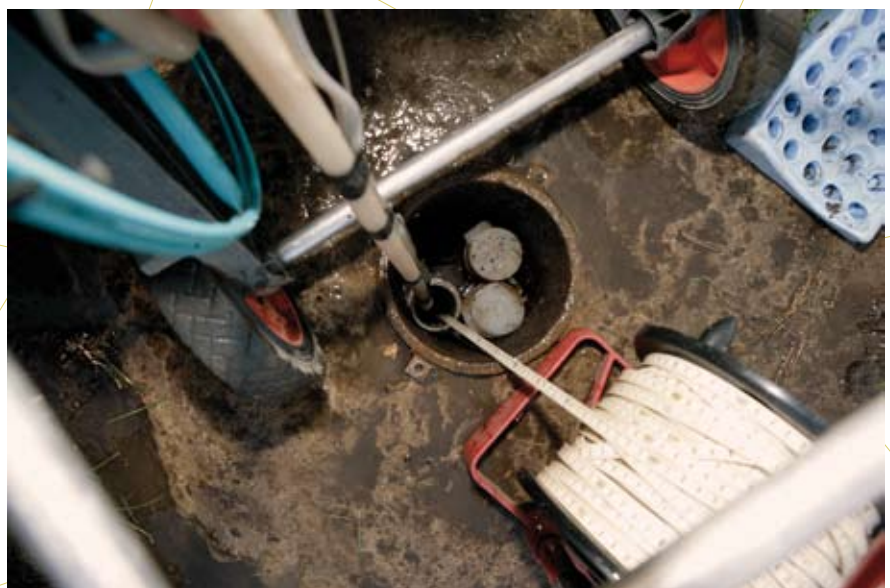
Boven: Ter plaatse worden er al een aantal analyses van het grondwater gedaan. Voor de overige analyses worden stalen naar het labo gestuurd. Onder: Op de meeste meetlocaties zijn er drie peilbuizen die elk tot op een verschillende diepte in de bovenste watervoerende laag reiken.
