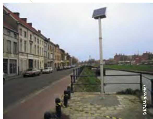
Elektronische meetstations helpen de problematische overstorten mee in kaart te brengen.
