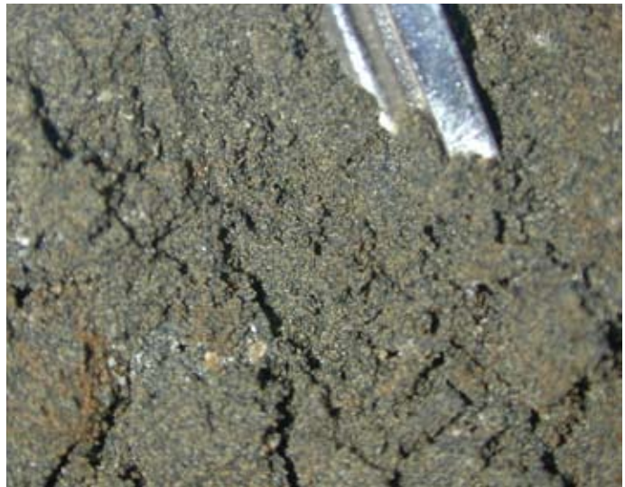
Fig. 4-4: Formatie van Berchem in een verkenningboring ten behoeve van de aanleg van de Liefkenshoektunnel.
