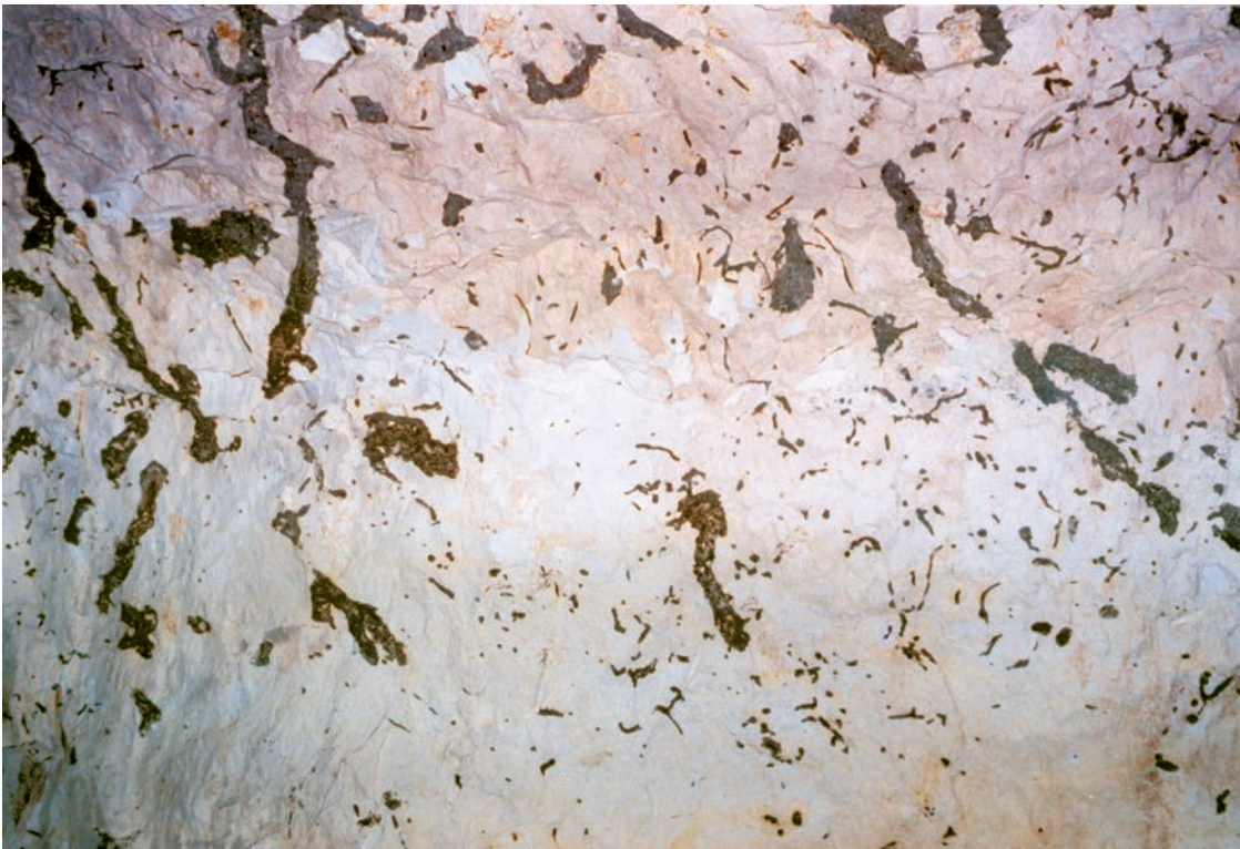
Foto 1: Bioturbaties gevuld met glauconietzand in de top van de Zevenwegen kalk onder de hardground in het dak van de ondergrondse krijtgangen te Biez.
