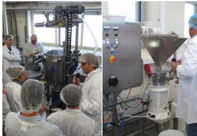
Bereiding van mayonaise met de vacuum high shear mixer in de Food Pilot
