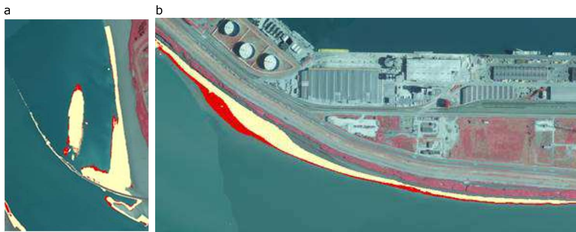
Figuur 12-3 Locaties met grote lage slikzone-veranderingen tgv erosie (rood) in de mesohaliene zone a)Ballastplaat, b) Plaat van Boomke
