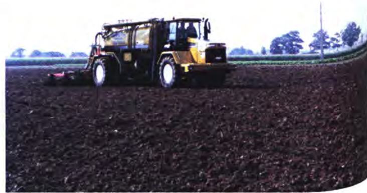
ILLUSTRATIE 52 Om de emissie van schadelijke stoffen te beperken, worden nieuwe technieken van bemesting toegepast, zoals de injectie van drijfmest in de grond (Bron: VLM, Fototheek, Centrale Directie Brussel)
