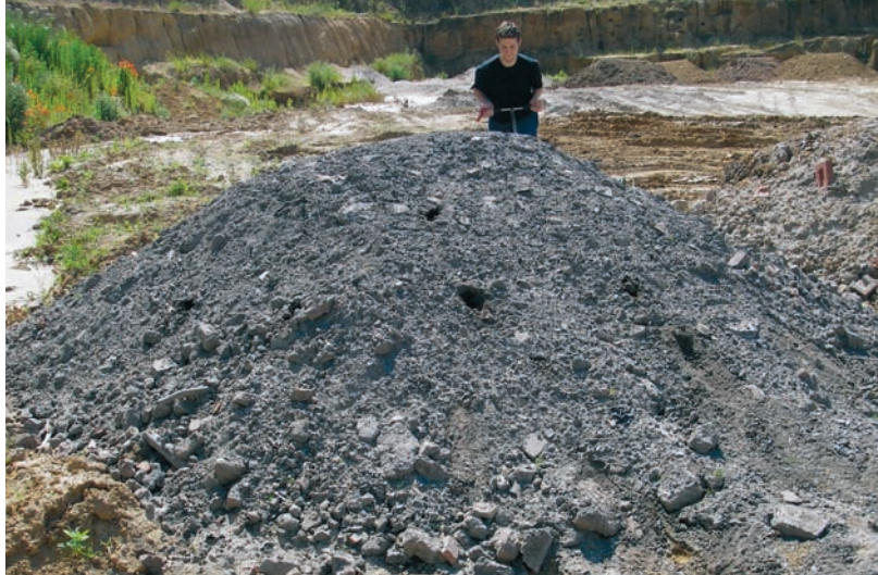
MI bemonstert een partij aangevoerde grond die in de groeve gestort werd
