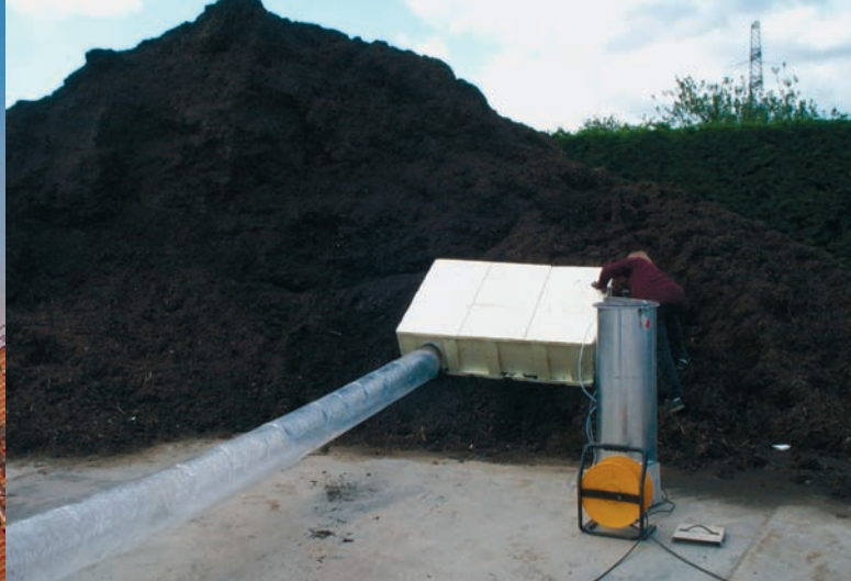
Meting van de geuremissie bij het compostbedrijf
