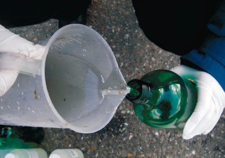
Het bedrijf gaf de opdracht aan een erkend laboratorium om het geloosde bedrijfsafvalwater maandelijks te bemonsteren: de concentratie aan broomhoudende vlamvertragers in het effluent daalde snel
