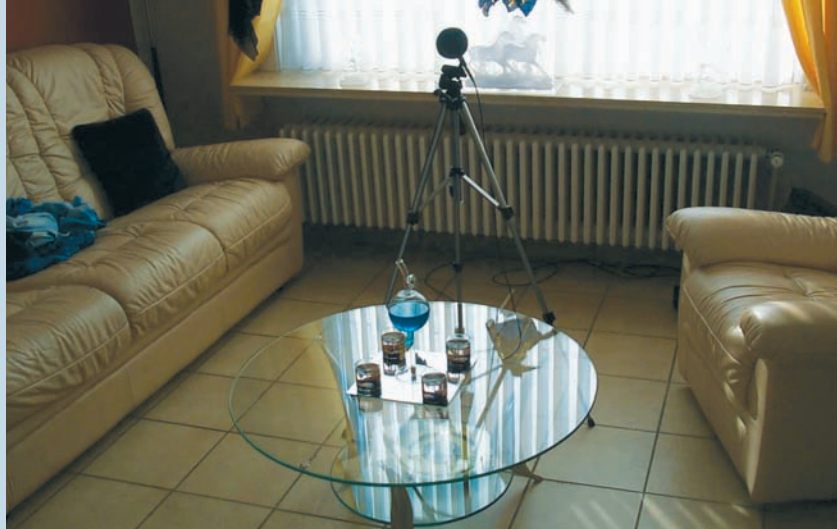
Geluids- en trillingsmetingen in de woning van de klager
