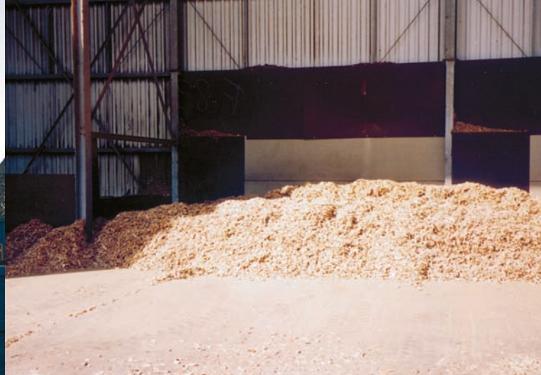
Het bedrijf verbrandt houtafval om stoom te produceren voor gebruik in de productie van polystyreenvoorwerpen
