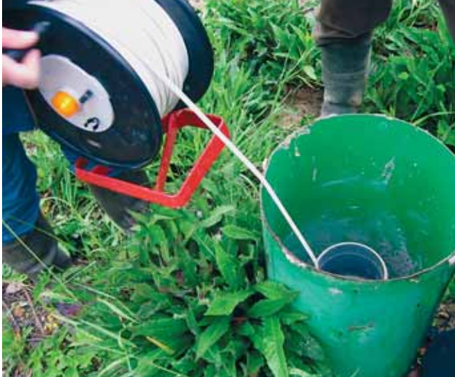
In de eerste plaats werd onderzocht of de meetputten rond de stortplaats op de geschikte plaats en diepte waren ingeplant.
