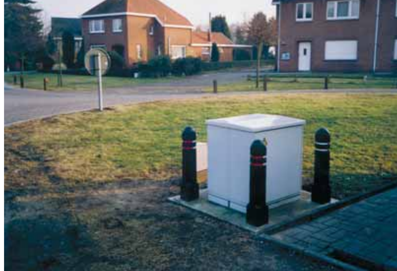
Geurmeetpost in een woonwijk rond de stortplaats voor continue meting van methaan.
