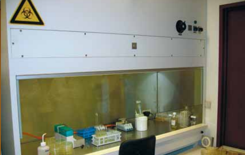
Bij gevaar voor de menselijke gezondheid moeten activiteiten met GGO's en/of pathogene organismen uitgevoerd worden in een microbiologische veiligheidskast.
