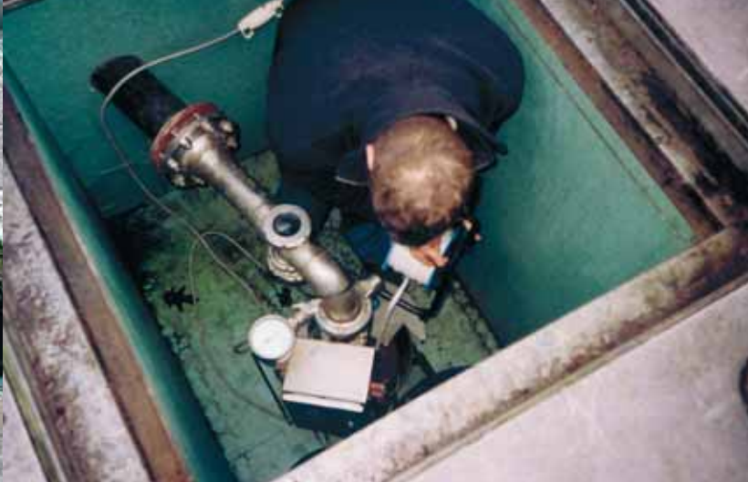
Uitvoering van een peilmeting bij een grondwaterwinning.
