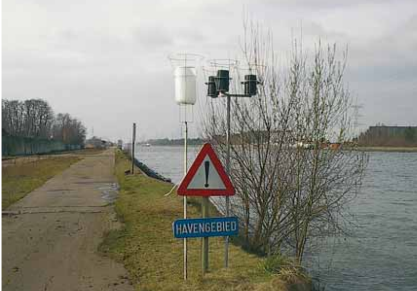
Opstelling voor de uitvoering van depositiemetingen.
