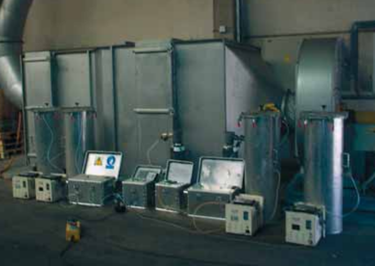
Simultane geurmetingen aan (v.l.n.r.) in- en uitgang van vetfilter, en uitgang elektrofilter gaven een idee van het geurverwijderingsrendement van de luchtbehandelingsinstallatie bij de vetmelter.
