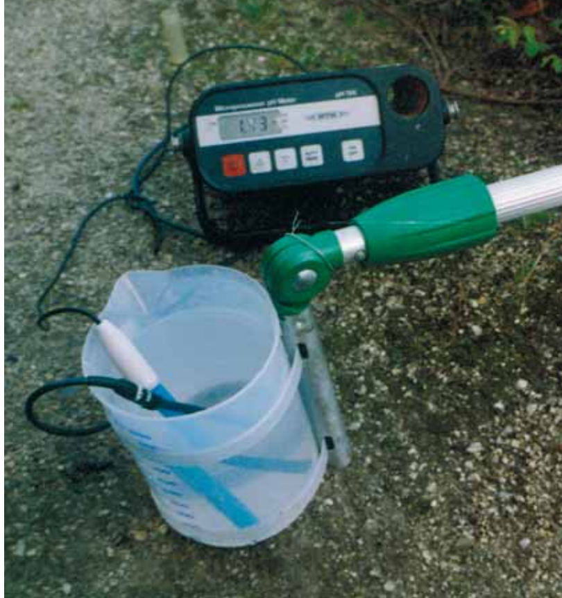
Meting van een extreem lage pH na een voorval.
