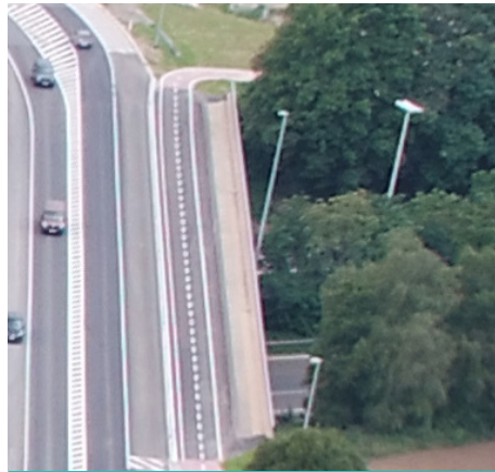
Randmarkeringen zijn belangrijk voor de geleiding van fietsers. Op dit fietspad maakt de randmarkering aan beide zijkanten de onverwachte bocht voorspelbaarder voor de fietser.
