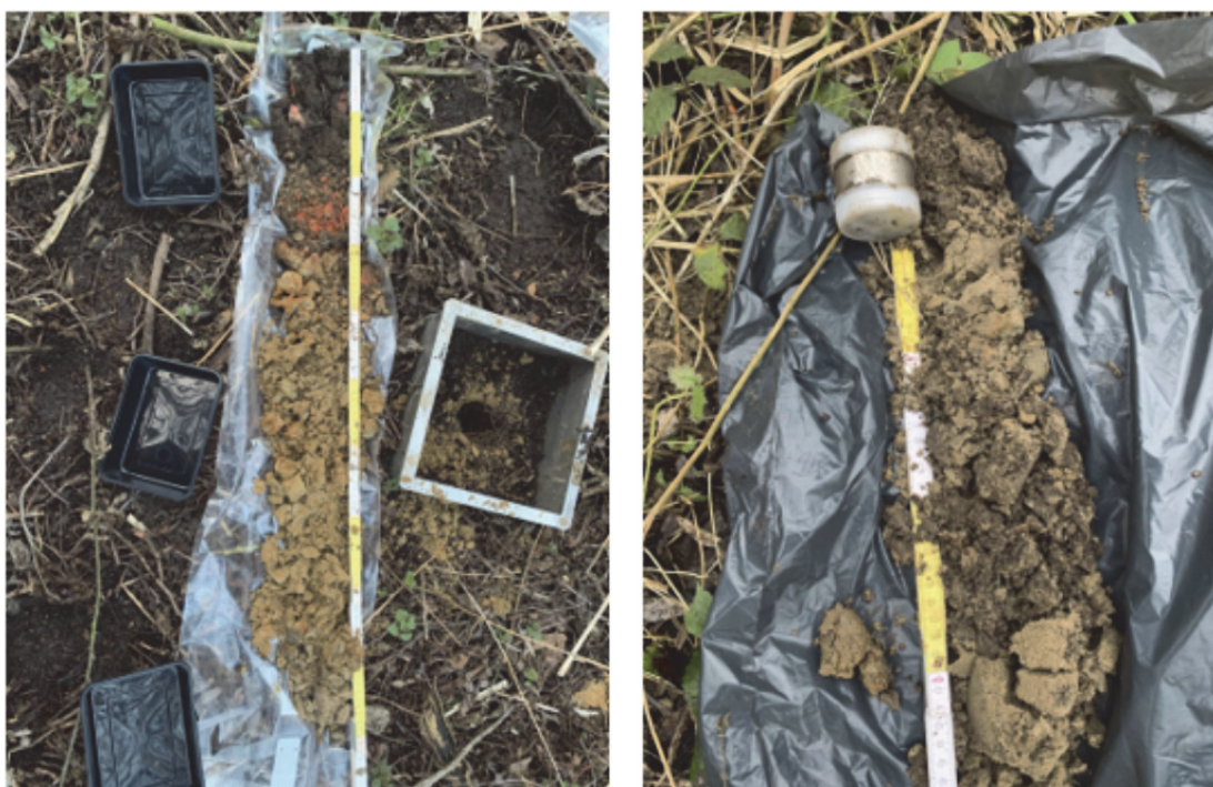
Figuur 3. Minerale bodemstaalname door profielboring: (links) boring binnen RVS kader na verwijderen strooisel - merk op rode kleur van baksteenresten tussen 20-30 cm (locatie BB16), (rechts) topsoil bemonstering op BB09: geroerde en ongeroerde staalname in gesloten Kopecky-ring.
