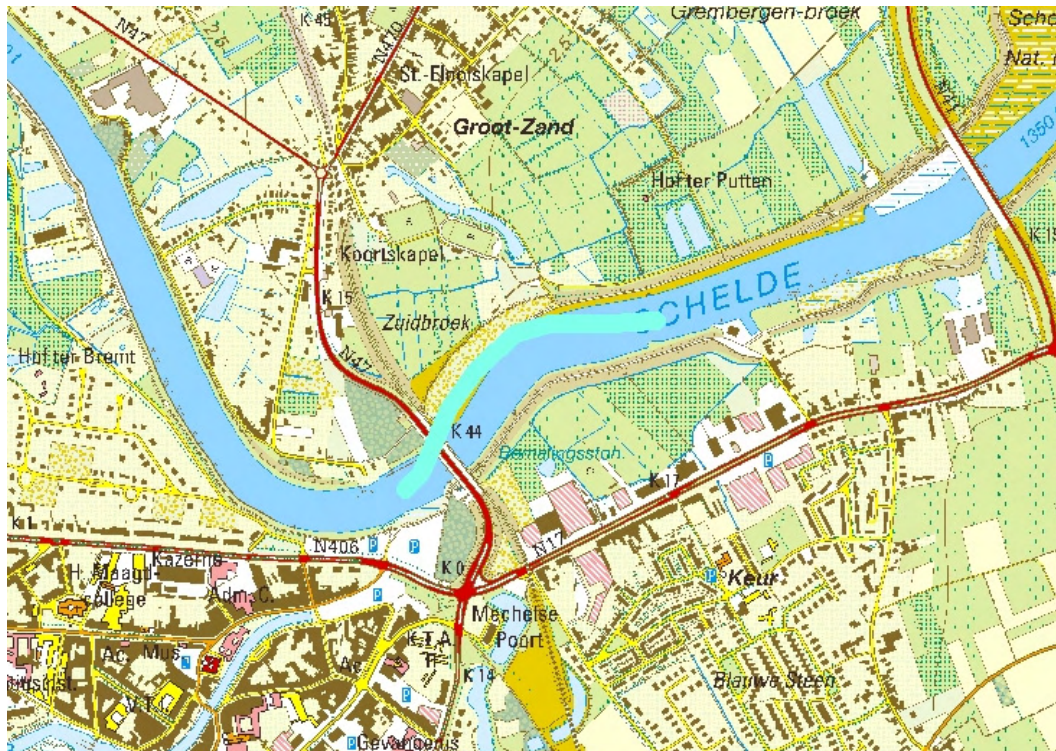
Figuur 3.68 "Rechttrekking" bij Dendermonde (eigenlijk meer een lokale verplaatsing van de loop van de rivier) / Canalization at Dendermonde (actually more like a local displacement of the river course)
