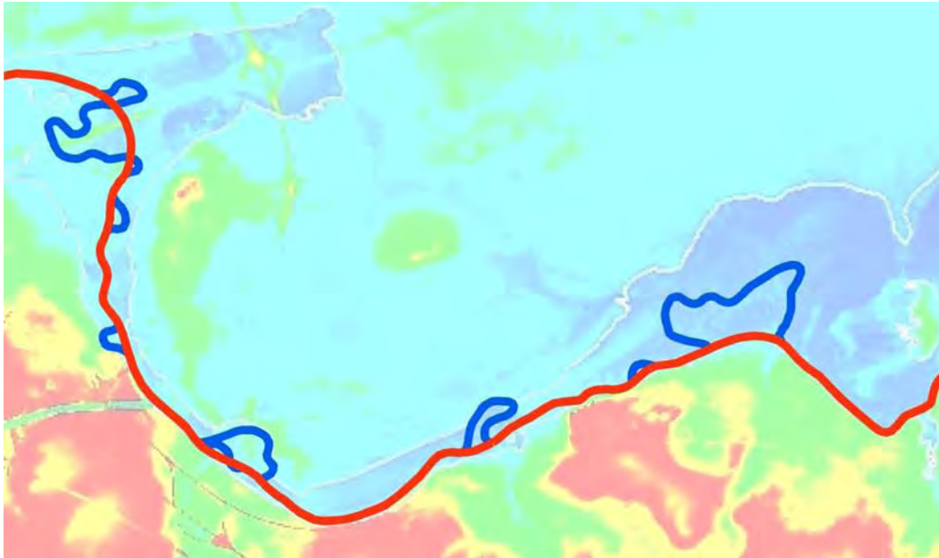
Figuur 3.61 Rechttrekkingen in de zoete zone met korte verblijftijd / Canalization of the fresh water zone with short retention time
