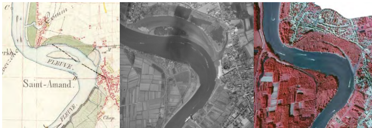
Figuur 3.29 De nevengeul ter hoogte van Sint-Amands was ten tijde van het gereduceerd kadaster nog sterk ontwikkeld, in 1956 was ze al grotendeels dichtgeslibd en in 2003 is alleen nog een smalle kreek overgebleven / A well-developed side channel of the Scheldt is found at Sint-Amands in 1850. In 1956 large parts are filled up with sediment and in 2003 only a small creek remained
