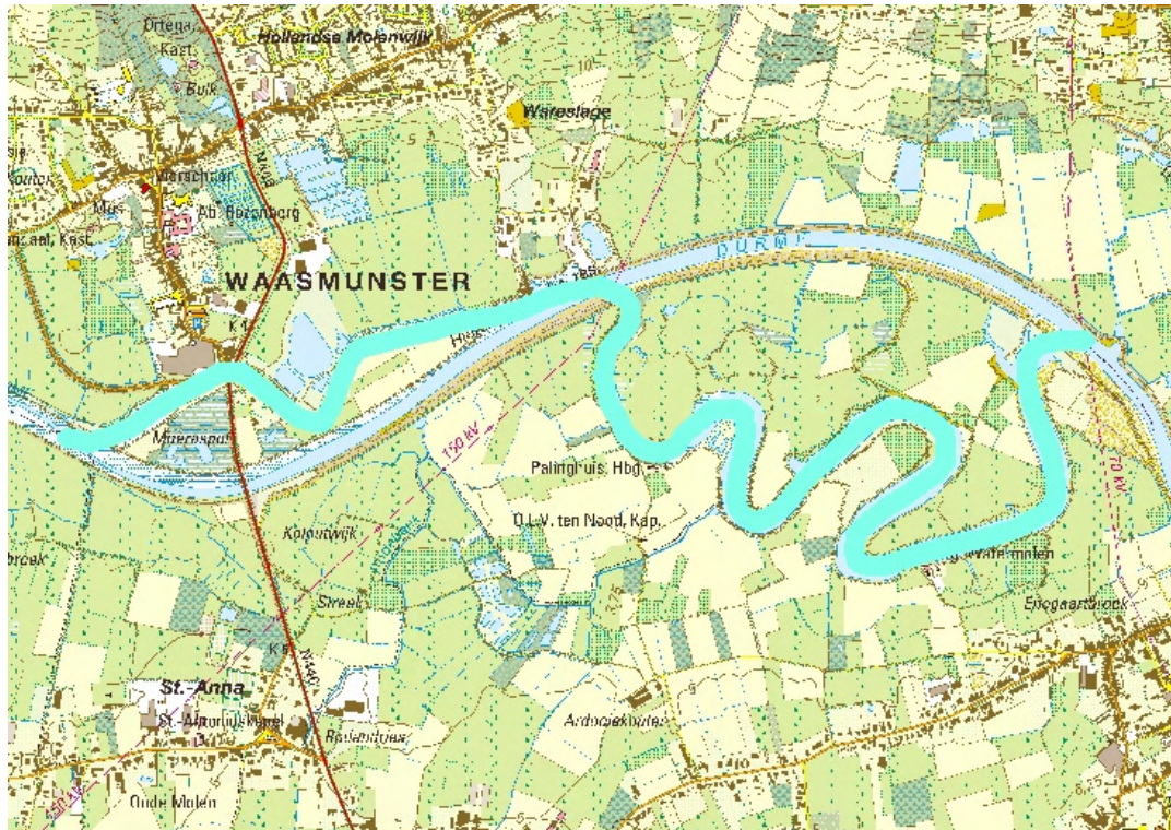
Figuur 3.62 Rechttrekkingen van de Durme bij Waasmunster / Canalization of the Durme near Waasmunster
