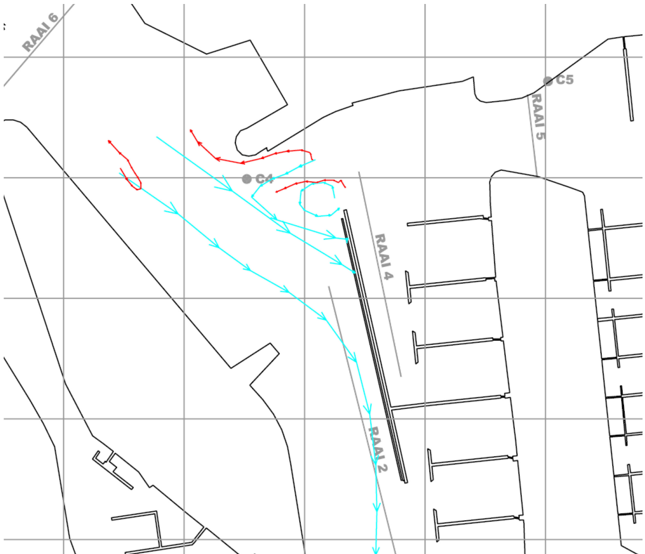
Figuur 16 – Voorbeeld resultaat van drijvermeting rond 2h voor HW. Rood is oppervlakedrijver. Lichtblauw is dieptedrijver op diepte 3m. (GEMS & IMDC,2006c)
