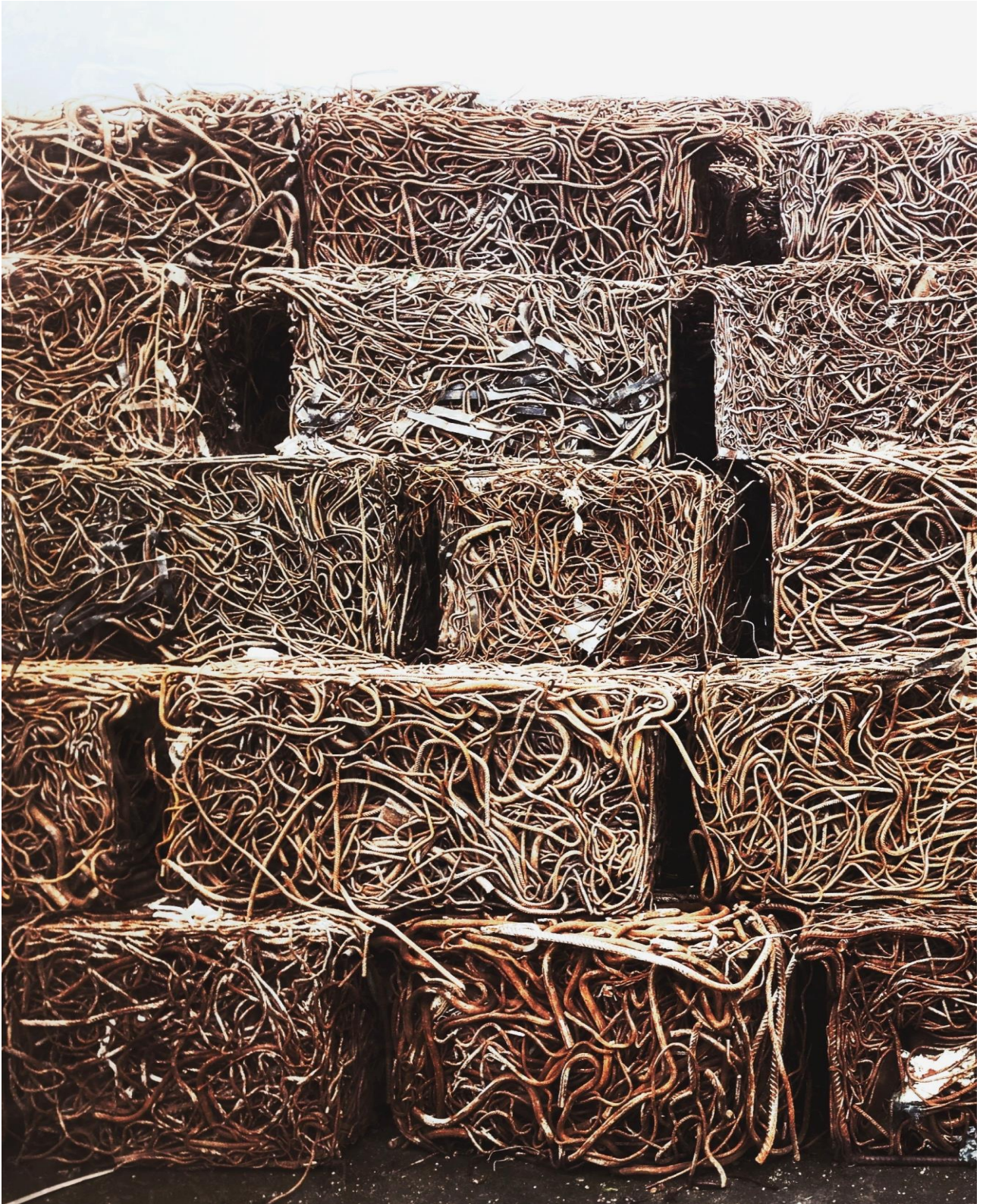
Tot balen geperste betonbewapening.
