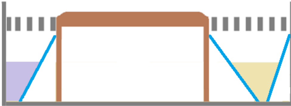
Figuur 65 PAS-4.4, schuine wand plaatsen in functie van het verlagen van het emitterend oppervlak
