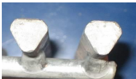
Figuur 5 Vorm van de roosterbalkjes bij een driekantrooster
