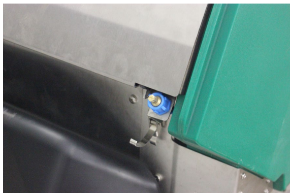
Figuur 5: Sproei-installatie op mestrobot
