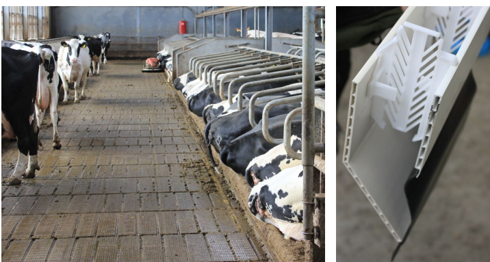
Figuur 26: Vloer met mestrobot en detail afsluitklep
