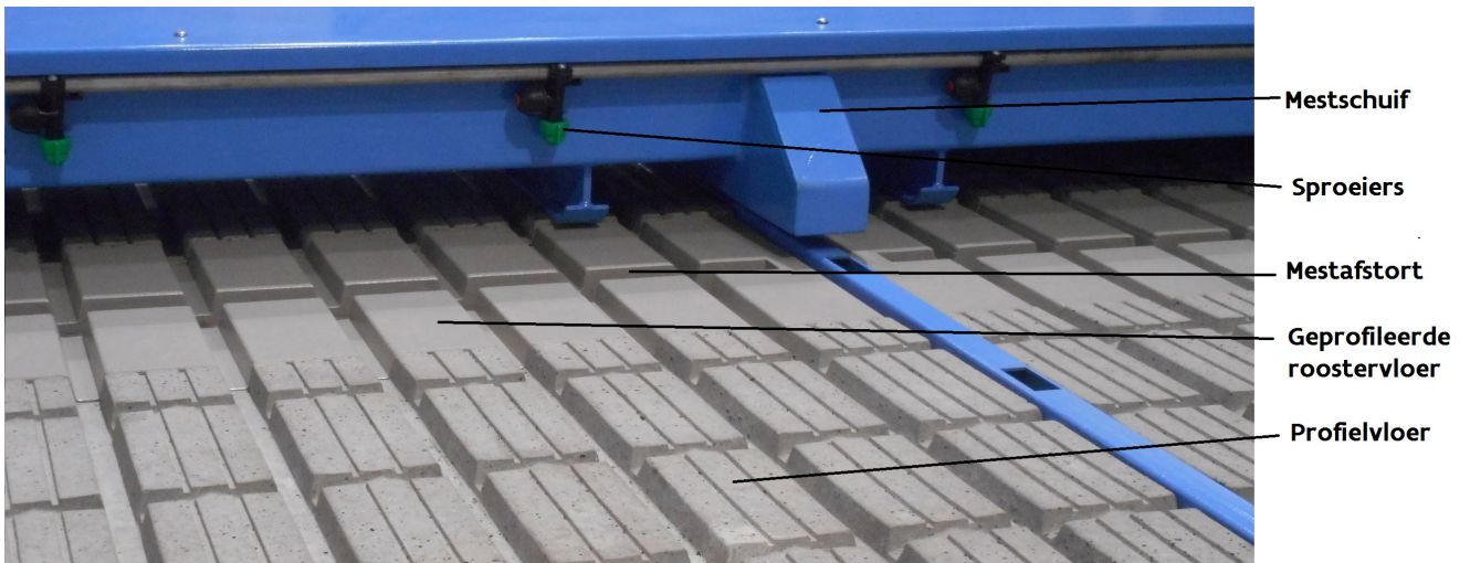
Figuur 11: Opbouw en verschillende onderdelen in vooraanzicht
