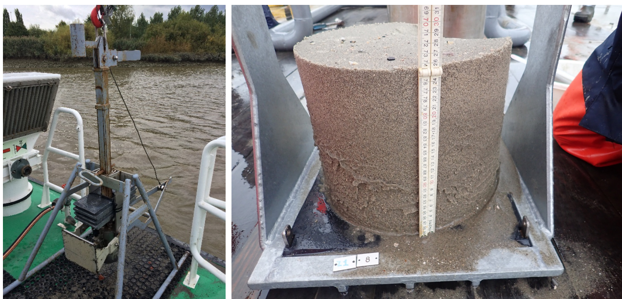
Figuur 1 – Boxcorer (links) en foto van één van de stalen genomen in de diepe put van Hansweert
