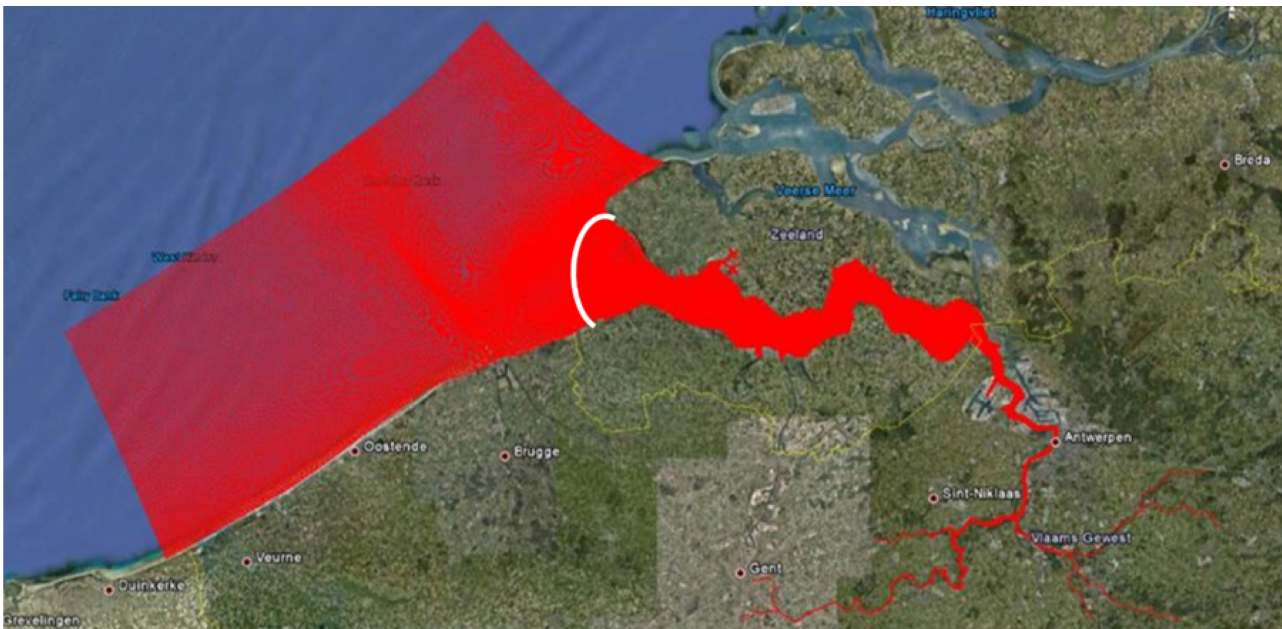
Figuur 7 – Illustratie van het Delft3D-NeVla rooster met locatie van de afgeknipte rand bij Westkapelle-Cadzand (witte lijn).
