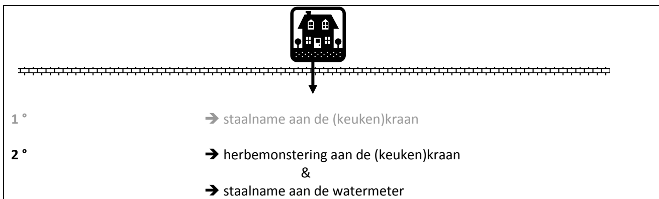
figuur 2: schematische weergave van de 'tweemonsterprocedure' voor de herbemonstering bij het vaststellen van een normoverschrijding aan de kraan
