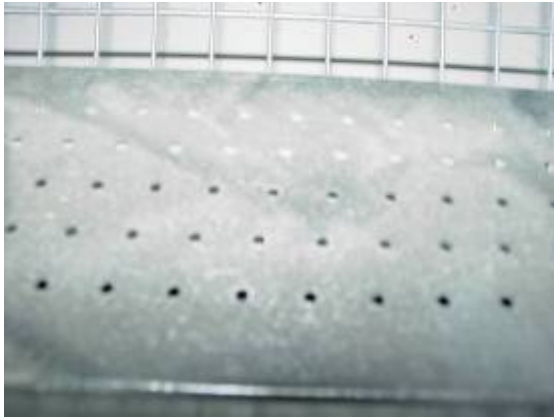
Figuur 10 Geponste gaten als nagelgarnituur
