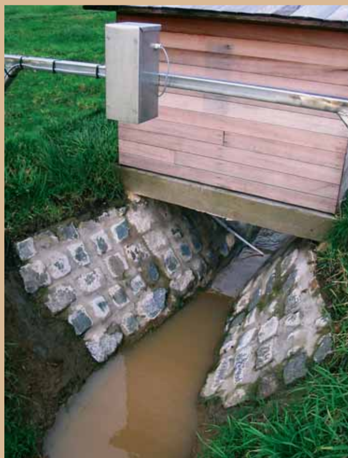
Foto 1: De meetgoot is het uitstroompunt van het stroomgebied. Er bovenop staat het meetstation.
