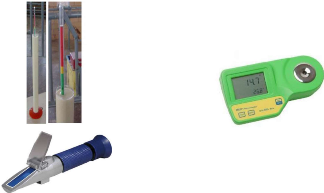
Figuur 1: colostrummeter eenvoudig model (boven links) refractometer optisch (onder) en refractometer digitaal (rechts). Bron: www.googleimages.com
