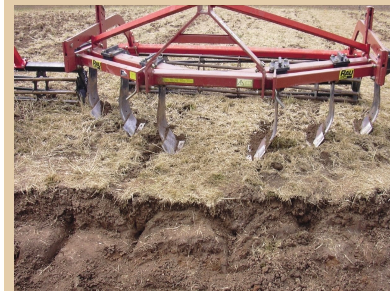
Een groot aantal woelers werd op Les Culturales gedemonstreerd, o.a. het type 'Dent Michel', door de landbouwer gepatenteerd.
