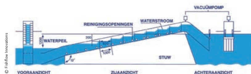
De provincie Vlaams-Brabant zal het migratieknelpunt aan de watermolen van Overijse oplossen met behulp van een hevel-vispassage.
