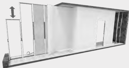
Prefab metalen frame dat aangepast kan worden aan de hoogte en breedte van de ruimte
