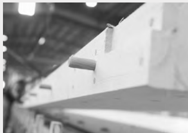
Houten componenten met deuvels verbonden © Optiholz
