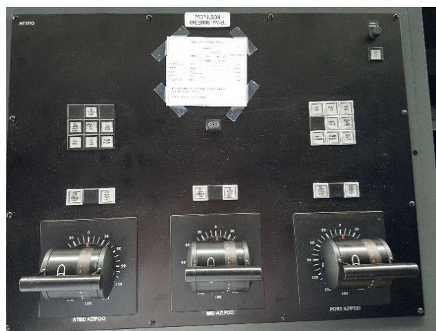
Figuur 1: Bedieningspaneel voor pods-stuering zoals beschikbaar op ARC7 LNG-tanker (links) en zoals geïmplementeerd op de simulator (rechts)
